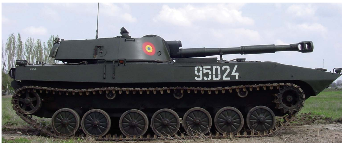
Obuzierul autopropulsat românesc, calibrul 122 mm, model 1989. A fost construit la uzina mecanică din Mizil.
