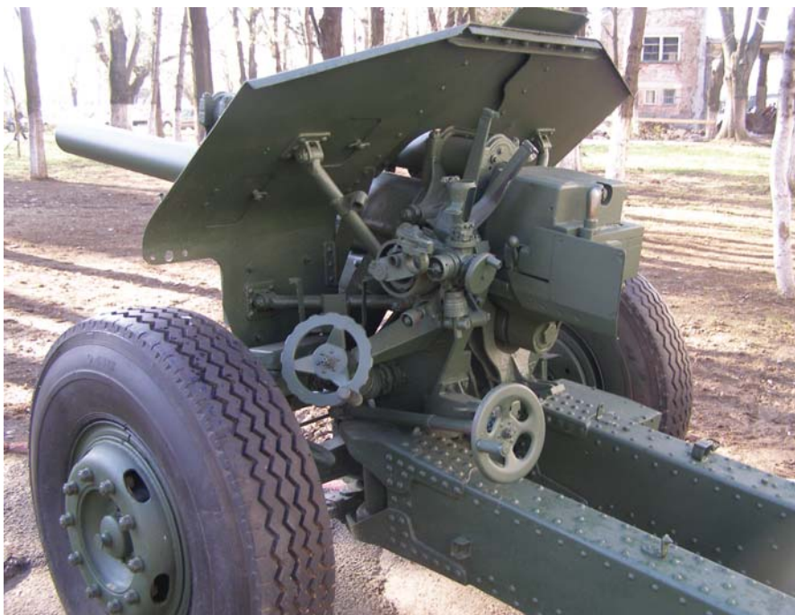
Obuzier M-30, cal. 122 mm "M" (modernizat). Imagine laterală stânga. Așa cum se poate observa, pentru lupta antitanc a fost montat încă un volan pentru ochirea în înălțime.
