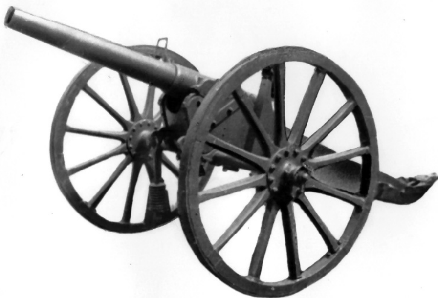
Tunul cu tragere încetă "Krupp", cal 75 mm, md. 1880/1916 transformat în tun antierian la Arsenalul Armatei din București.
