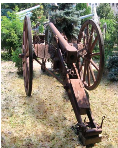
Tun "Krupp" calibrul 78,5 mm, model 1871. Această piesă a fost capturată de Armata Română în războiul de independență de la turci. Construcția piesei este asemănătoare modelului 1868, afetul fiind însă metalic. (Muzeul Militar Național).
