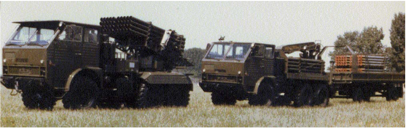
Aruncător APRA-40, model 1988 și mașina de realimentare cu muniție. Aceasta transporta 2 pachete a câte 20 de proiectile, în caroserie și 4 pachete a câte 20 de proiectile în remorcă.
