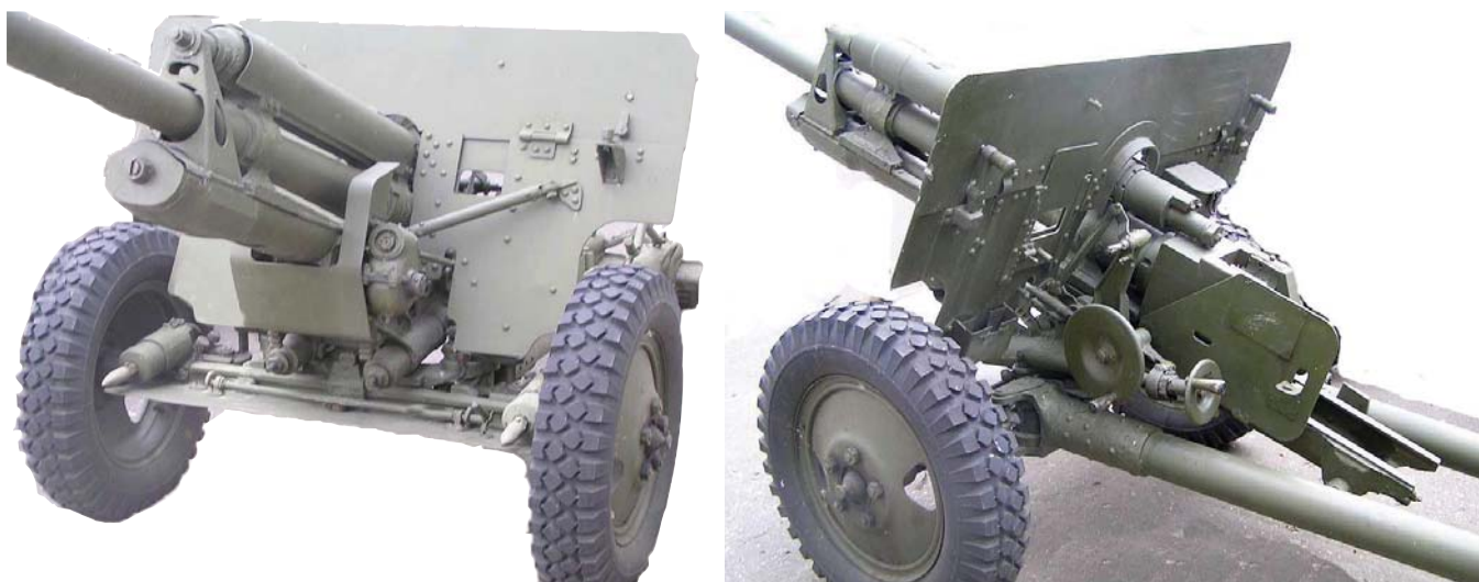
Tun antitanc ZiS-2 la muzeu. Partea superioară a scutului se rabata către înainte. Sub osie exista de asemenea un scut de protecție. Se poate observa asemănarea evidentă cu modelul ZiS-3.
