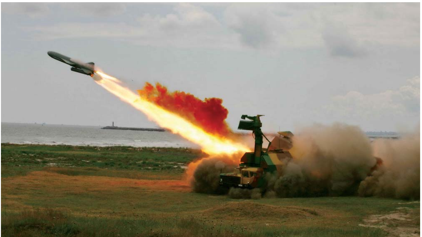
Instalație de lansare mobilă aparținând Forțelor Navale Române, în timpul lansării rachetei P-21. Se poate vedea, sub rachetă, motorul de start cu combustibil solid și începerea funcționării motorului de marș.
