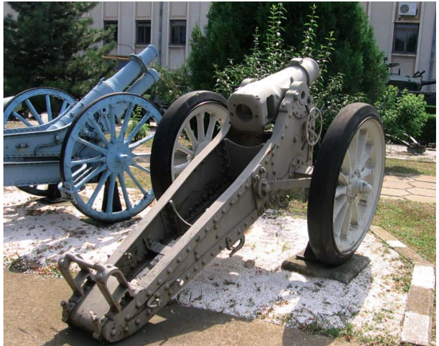
Mortierul “Skoda”, calibrul 150 mm, model 1880. Această piesă a fost capturată de Armata Română de la trupele austro-ungare în primul război mondial. Roțile nu sunt cele originale. Descrierea Muzeului Militar Național este greșită, mortierul fiind prezentat ca având calibrul 155 mm.
