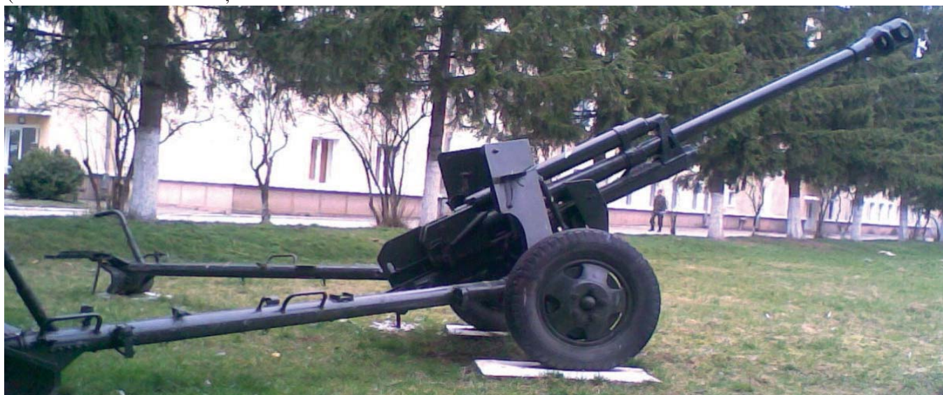
Tun "Reșița", vedere laterală. Se observă scaturile curbate ca la tunul german "PaK40".
