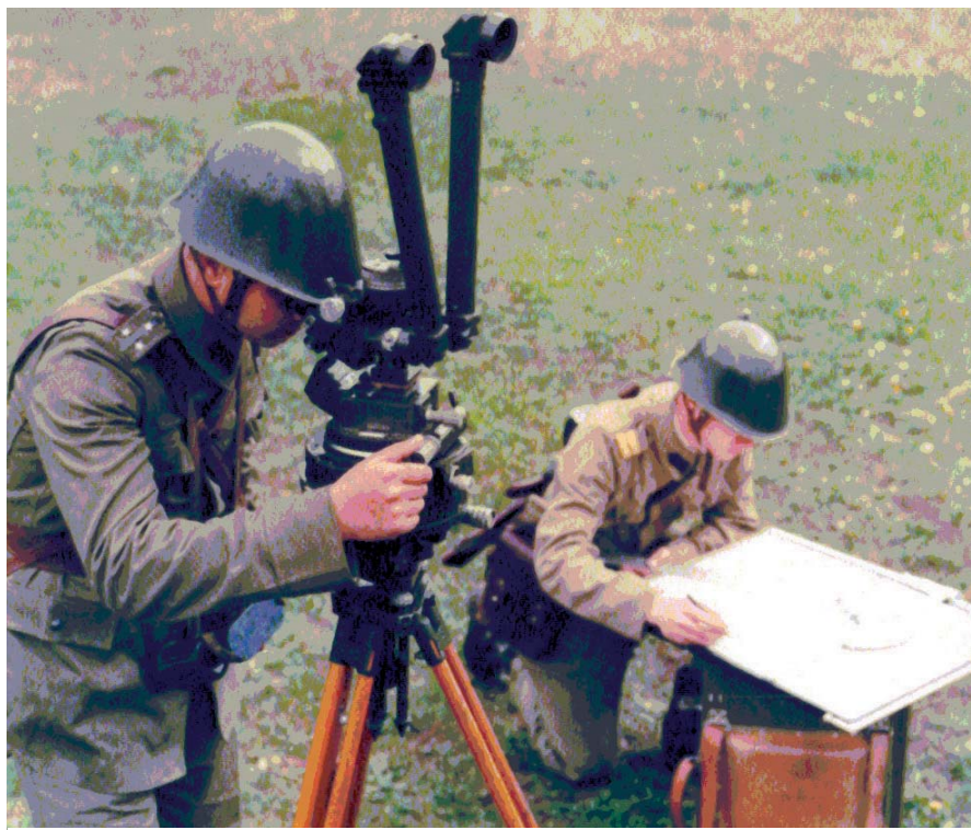
Anii '80. Ofițer executând reglajul tragerii cu A.R.O.T.A.T.-ul („Aparatul de reglaj prin observarea tragerilor artileriei terestre”). Aparatul a fost realizat în România și permitea executarea reglajului tragerii cu majoritatea calibrelor din dotare. În dreapta este „calculatorul”, gradatul care lucrează cu „Aparatul de conducere a focului artileriei” - A.C.F.A.
