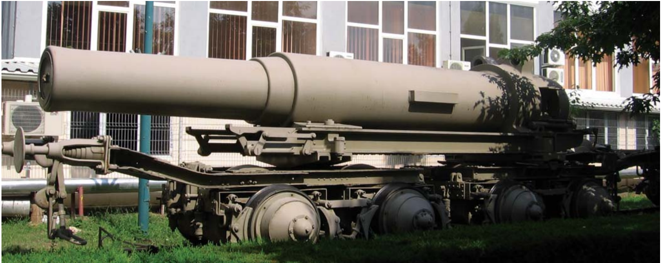
Teava cu lungimea de 6,46 m a obuzierului "Skoda", cu denumirea "Gudrun", calibrul 38 cm, model 1916. Este așezată pe o platformă de cale ferată. Piesa este în colecția Muzeului Militar Național din București.
