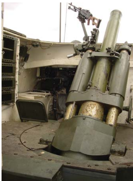
Detaliu cu interiorul MLVM în care este dispus aruncătorul cal. 120 mm.
