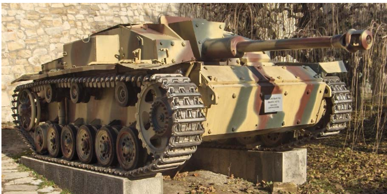
Tun de asalt StuG III Ausf. Unele dintre tunuri aveau câte o apărătoare de tablă în părțile laterale.
