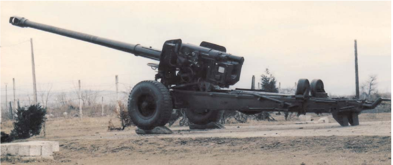
Tun calibrul 130 mm. Era tractat cu autocamionul DAC 6x6 sau cu autovehicolul șenilat ATS-59 G.
