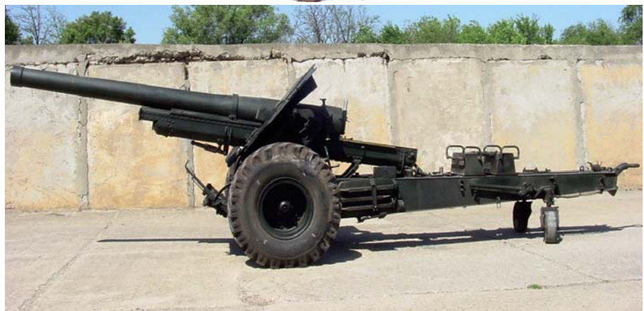
Obuzierul “Skoda”, calibrul 150 mm, model 1934 modernizat. Pe fâlcușul stângă se observă: cutiile sabelor, cricul pentru rabatarea roții de ma- nevră și 3 din cele 6 sape.
