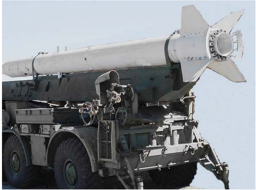
Detaliu cu postul ochitorului la instalația de lansare 9 P-113. Se pot remarca volanele mecanismelor de ochire și înălțătorul mecanic cu paharul lunetei.
