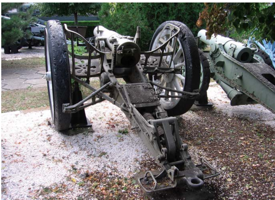
Obuzier de câmp “Skoda”, calibrul 104 mm, model 1899 din colecția Muzeului Militar Național capturat de către Armata Română în anul 1917. Se poate vedea sistemul de atenuare a reculului format din sapa mobilă și resortul dispus la fălcele. Roțile cu bandaj de cauciuc nu sunt originale.
