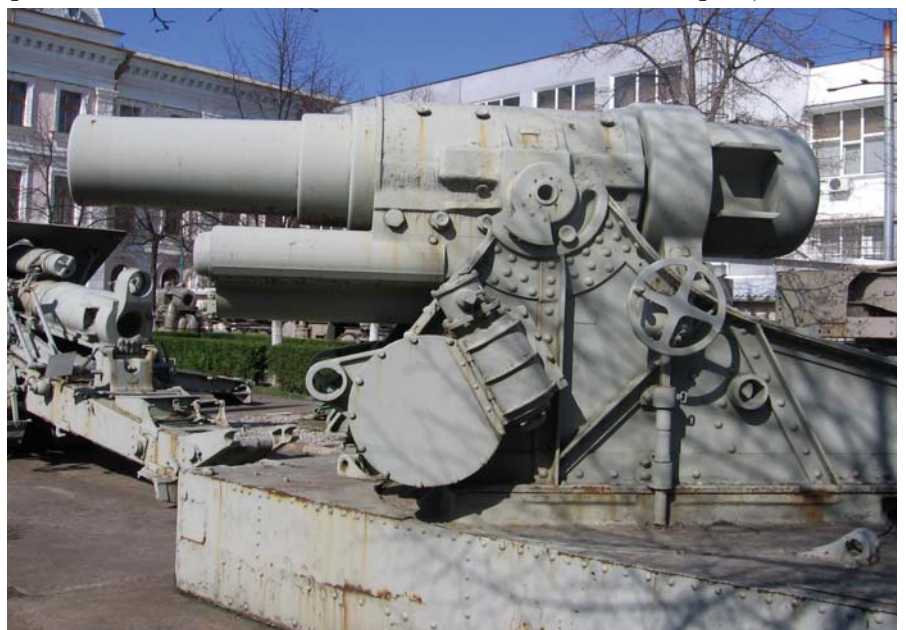
Mortier "Skoda", calibrul 305 mm, model 1916. Afetul piesei este mai modern. Se observă diferențe constructive în special prin dispunerea legăturii elastice sub țeavă. Piesa din colecția Muzeului Militar Național din București.
