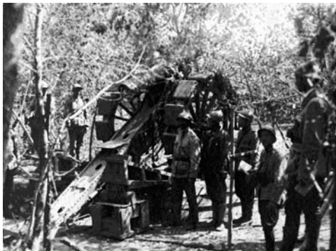
Tun românesc cal. 120 mm din primul război mondial având roțile ridicate pe platformă pentru a se obține unghiuri mari de nivel ale țevii.
