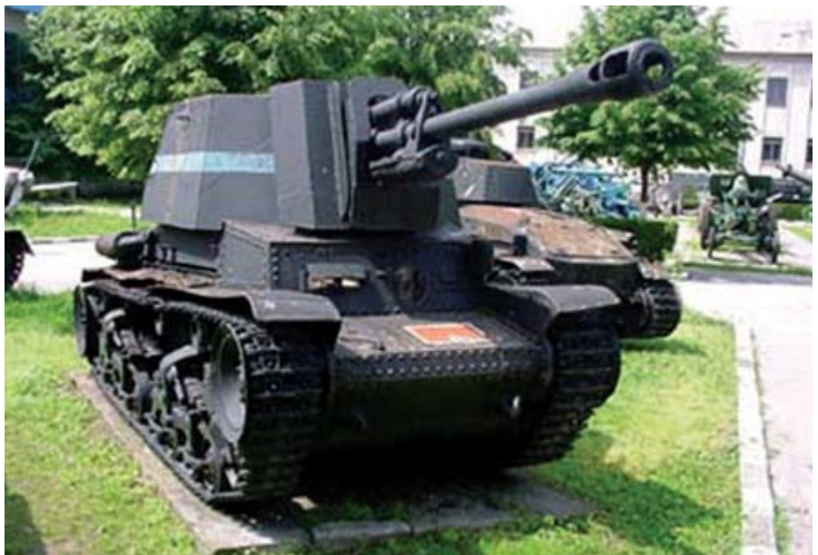
Autotunul “ TACAM R 2 ”. A fost realizat prin transformarea tancului ușor cehoslovac “ Skoda LT 35 ”, indicativ românesc R 2 . Dunga albastră de pe mijloc semnifică faptul că era tancul comandantului de subunitate.
