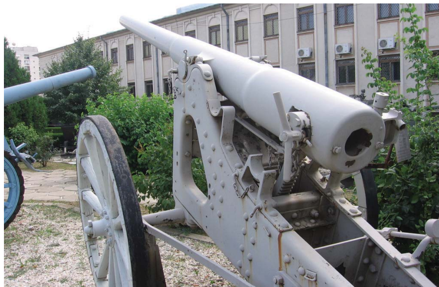
Tun "Krupp", cal. 105 mm, model 1891/1916 din colecția Muzeului Militar Național. Trăgea obuze de ruptură, explozive de fontă sau șrapnele (cu 210 gloanțe a 210 g) cu greutatea de 16 kg și mitralii.
