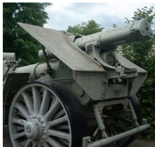
Mortier "Skoda", calibrul 210 mm, model 1916. Este o piesă de o valoare deosebită, care a fost produsă în doar două exemplare. Piesa din imagine este în colecția Muzeului Militar Național din București.
