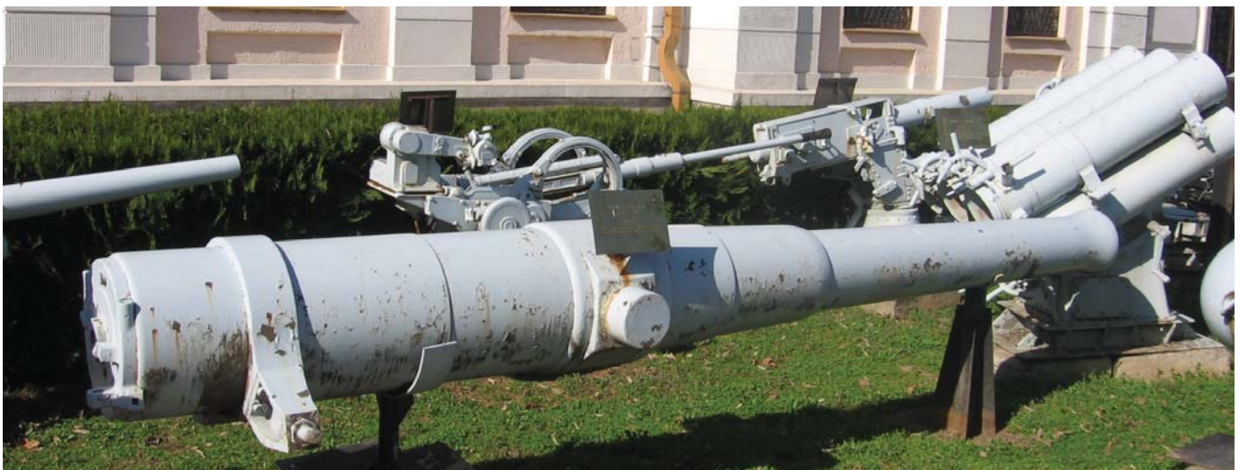
Tun naval „Armstrong”, calibrul 152 mm, utilizat din anul 1926 la artileria de coastă.
