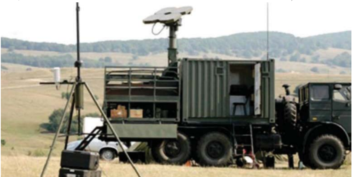
Stația meteo "Vaisala" dispusă pe camionul DAC 665 T. Este destinată întocmirii buletinelor meteo pentru artileria terestră.
