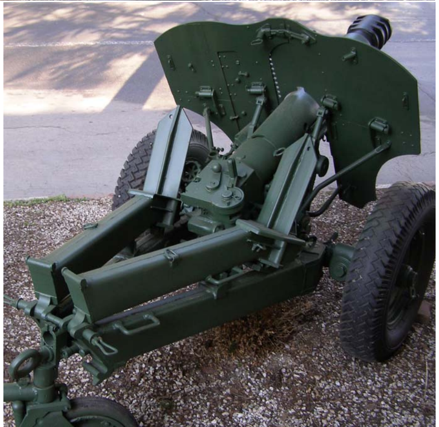
Tunul de munte cal. 76 mm, model 1981. Se remarcă construcția specifică pentru un transport facil: fâclțele care puteau fi strânse și roata ajutătoare.
