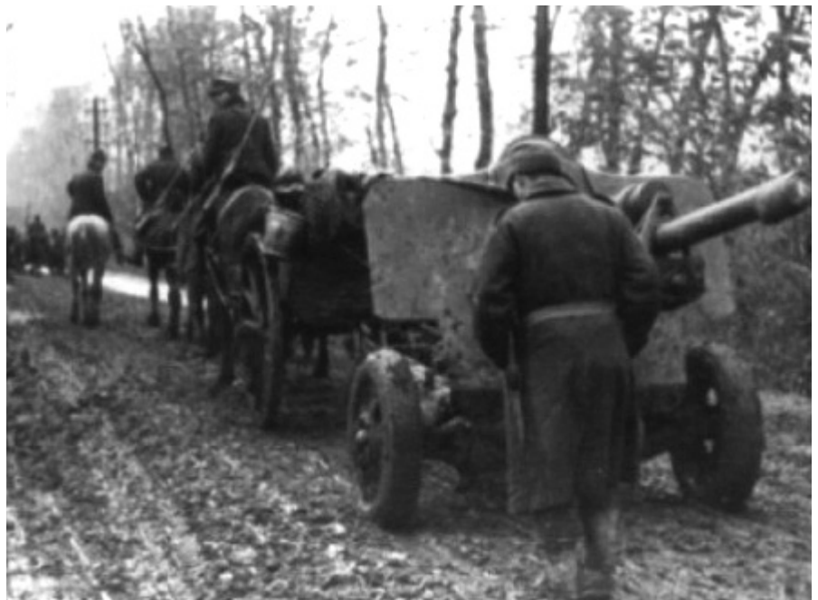
Tun divizionar F-22 USV pe frontul de est. Se poate observa antetrenul de proveniență diferită pentru a putea fi tractat hipo.
