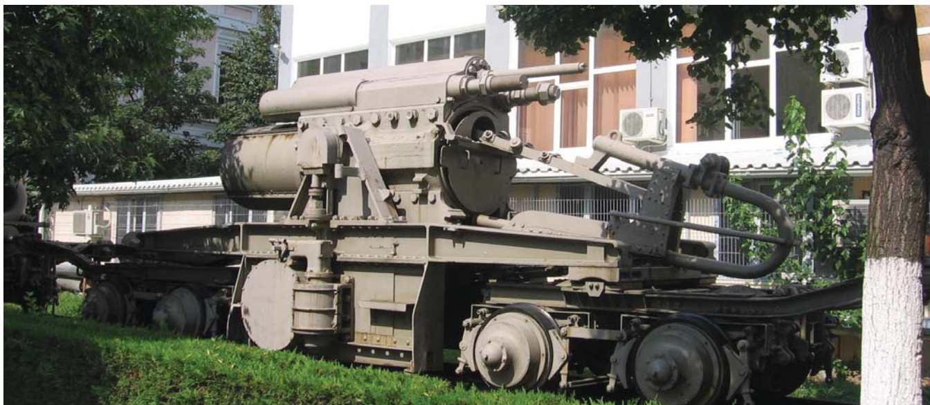
Afetul cu legătura elastică și dispozitivul de încărcare ale obuzierului "Skoda", calibru 38 cm, model 1916 așezate pe 2 osii duble de cale ferată. Întreaga platformă se putea ridica cu cricurile (unul este vizibil în lateral) și se așeza pe roți metalice apoi pe sol. Este cea de-a doua componentă a obuzierului. Muzeul Militar Național din București.
