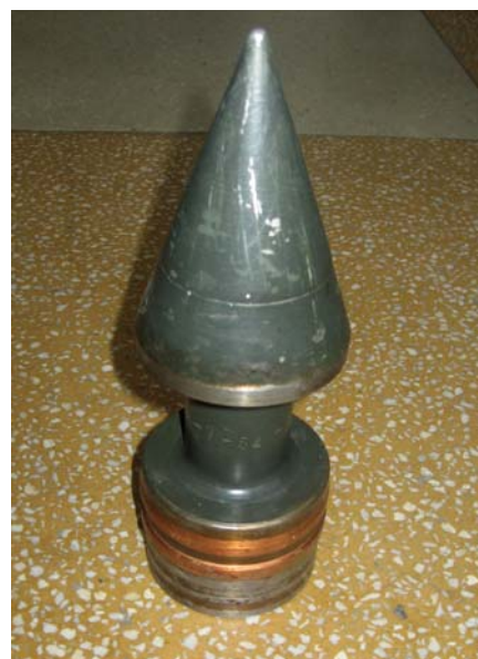
Proiectil perforant-trasor subcalibru BR-365P pentru tunul de 85 mm. La partea inferioară se observă brâul forțator dublat, din cupru. Acesta îi asigură proiectilului mișcarea de rotație pe traiectorie.
