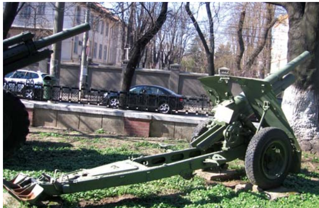
Obuzier “Skoda” cal. 100 mm, model 1939 modernizat cu roți metalice și anvelope de cauciuc. Exemplar aflat în curtea Muzeului Militar Național.
