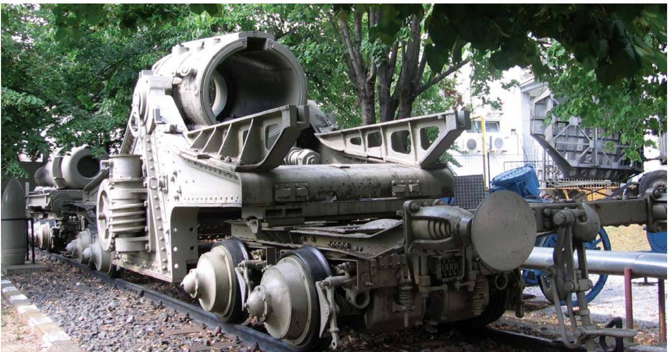
În prim-plan este afetul obuzierului de 42 cm, model 1916. În plan îndepărtat se vede țeava. Obuzierul se găsește la Muzeul Militar Național din București și este compus din două platforme, pe calea ferată. Este o piesă de artilerie unică, pe plan mondial.
