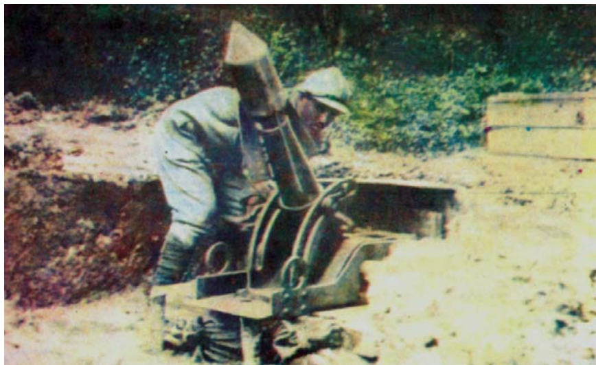
Mortier Nr. 2, cal. 58 mm pe frontul românesc, la Mărășești. Se remarcă diametrul bombei care era mai mare decât cel al țevii.
