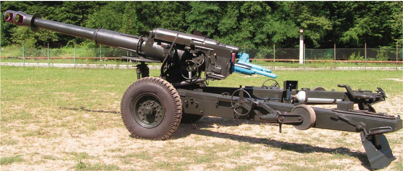
Obuzierul calibrul 152 mm, model 1981. La culată, se vede dispozitivul pentru ușurarea încărcării (albastru).
