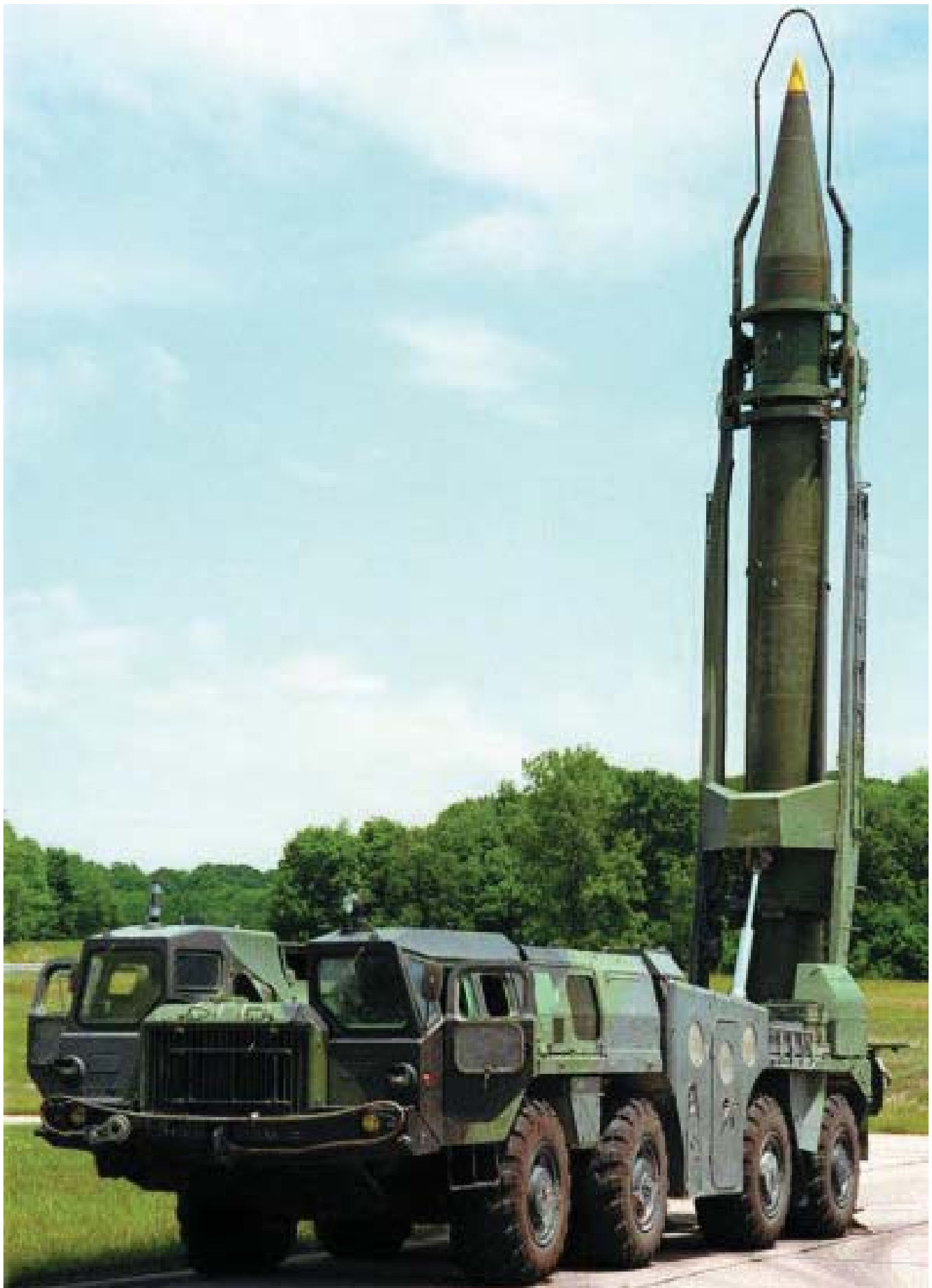
Instalația de lansare 9 P 117 M1 cu racheta 8 K 14 în poziție verticală. Pentru lansare trebuia să fie coborâtă "săgeata" (sistemul de ridicare, care, așa cum se vede în imagine susține racheta).
