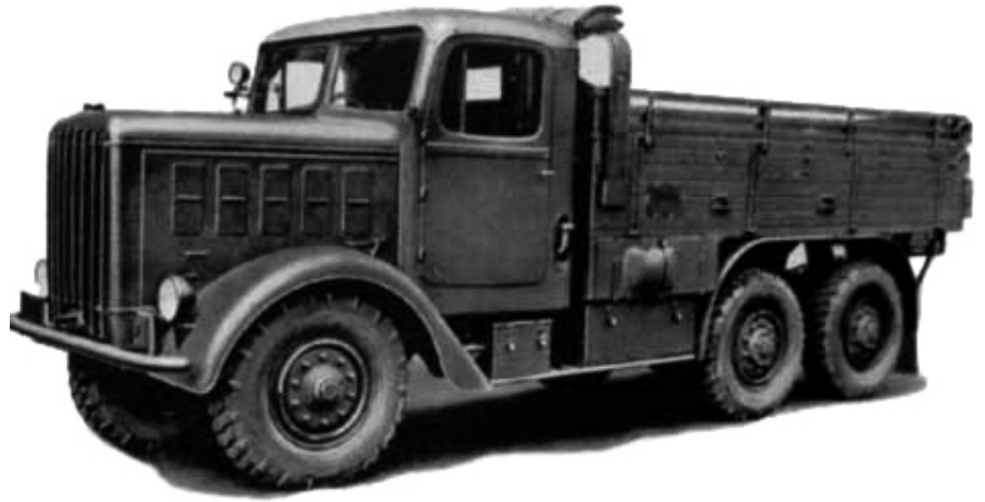
Camion "Skoda" 6 ST 6 T (6x4) utilizat pentru tractarea obuzierelor cal. 150 mm, model 1934. Greutatea 7,3 tone. Capacitatea de remorcare: 5,5 tone. Era dotat cu cabestan cu capacitate de tractare de 5 tone.
