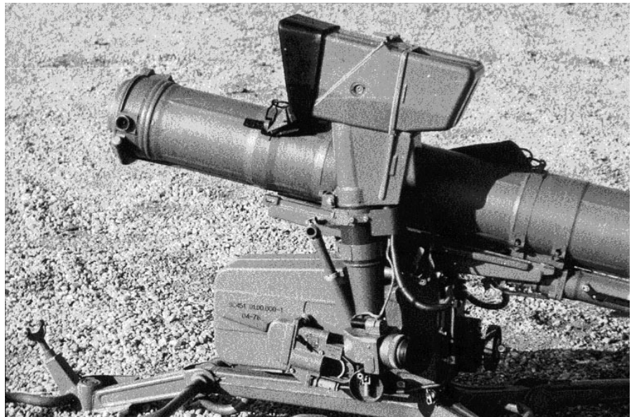
Instalație de lansare portabilă 9 P 135 cu rachetă “Fagor”. În partea centrală se poate vedea aparatul de ochire 9Sh119 iar în plan îndepărtat, după afetul tripod, cutia de dirijare 9S451.
