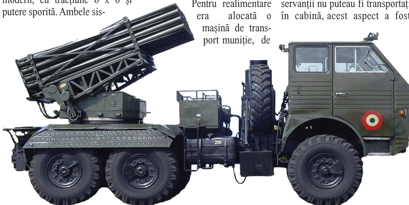
Aruncătorul de proiectile reactive 40-APRA-122-C, calibrul 122 mm, model 1988. Este dispus pe autoșasiu de tip DAC 665 T. Față de mod.1978 are containere de muniție și apărătoare/platformă la roțile din spate.
