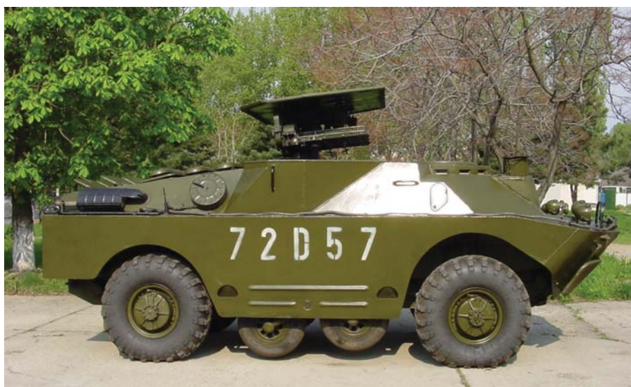
Instalația de lansare 9 P 133 pe BRDM-2. Echipajul era format din 2 oameni.
