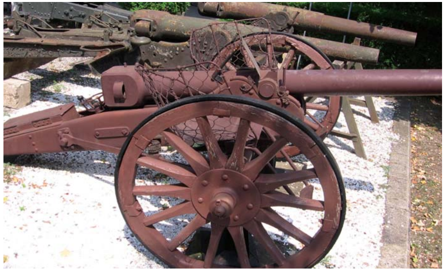
Tun turcesc “Krupp”, calibrul 78,5 mm. Are o construcție simplă cu afet metalic. Pe osie sunt dispuse două scaune pentru servanți.
