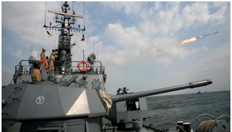
Jos: Tun calibrul 100 mm amplasat în turelă dispusă pe unul din monitoarele fluviale ale Forțelor Navale. Aspect de la desfășurarea unui exercițiu cu trageri de luptă în Marea Neagră.
