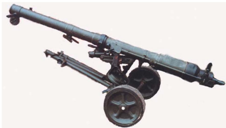
Tunul fără recul cal. 82 mm, B-10 dispus pe trenul rular. Pentru tragere se fixa pe afetul tripod.
