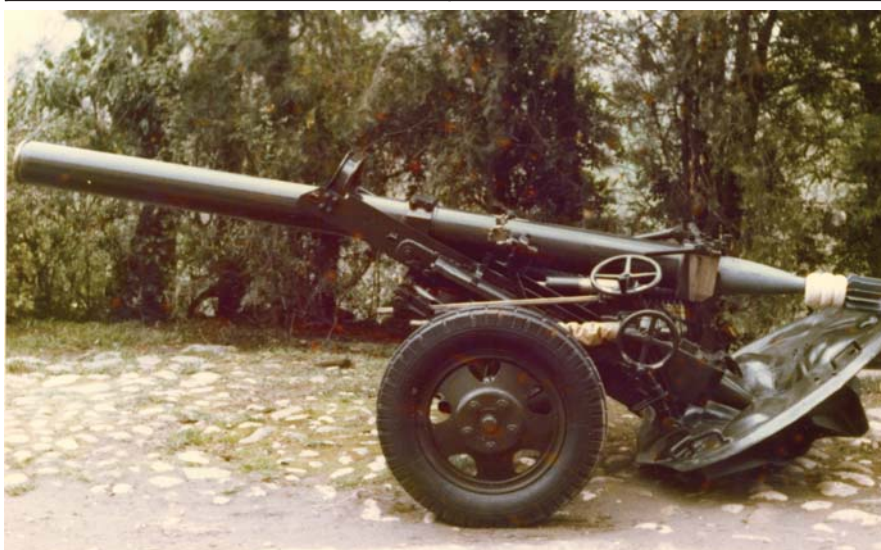
Aruncătorul MT-13 în timpul încărcării bombei F-852. Încărcarea bombei se făcea pe la culată prin rabaterea către înainte a leagănului cu țeava.
