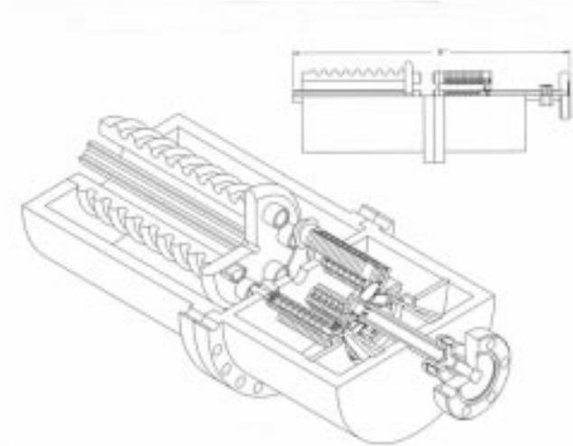
**Fig. 18** W-Band Modular Klystron
