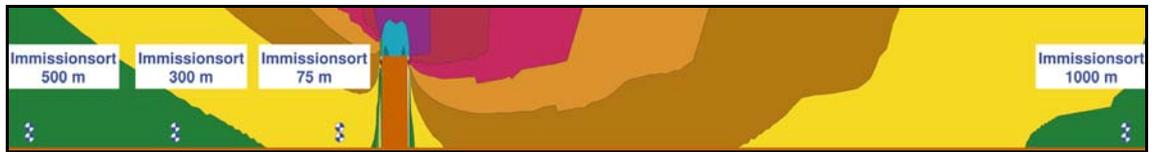
**Abb. 76** Lärmpegel nachts (LrN), Referenzquerschnitt 2, Richtgeschwindigkeiten
