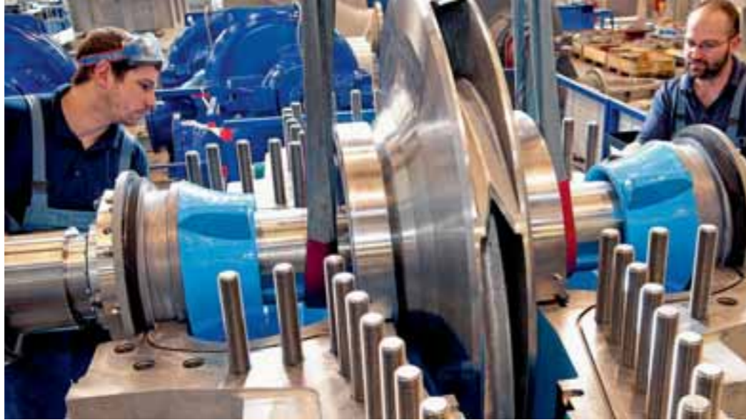
Montage einer Wassertransportpumpe am KSB-Standort Halle (Salle)
