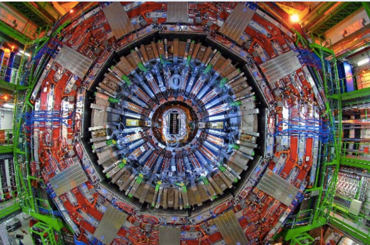
Bild des CMS-Experiments am LHC während der Bauphase am CERN in Genf. Der Detektor hat einen Durchmesser von ungefähr 16 Meter, ist 21 Meter lang und hat ein Gewicht von 12.500 Tonnen.
