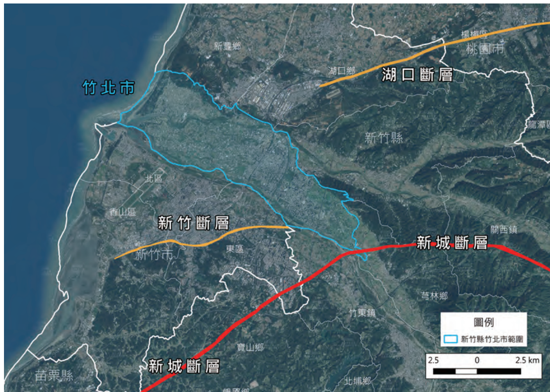
【圖 2-1-20】臨近竹北地區之三條斷層位置示意圖（李至堉繪製） 39
