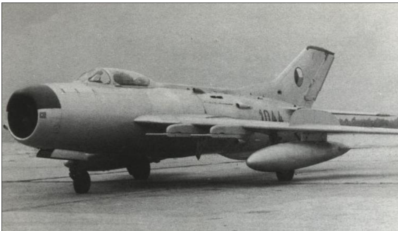
MiG-19PM č. 1044 s dvojicí přidavných nádrží po 760 l (fotografie pochází pravděpodobně z doby jeho služby u 5. slp v Plzni-Líních v 2. pol. šedesátých let). Letoun stejné verze pilotoval 16. 4. 1964 příslušník 1. slp z Českých Budějovic mjr. Miroslav Valášek.
