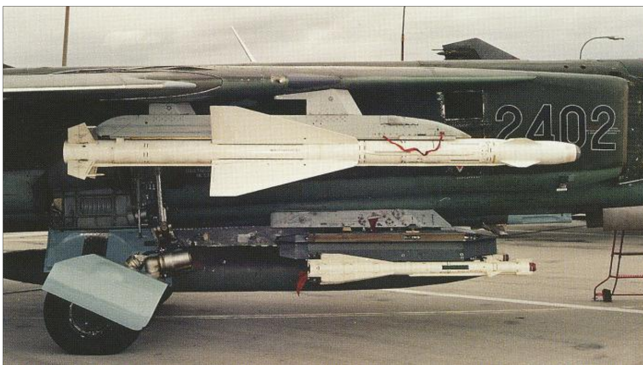
Nejčastější konfigurace výbroje MiGů-23ML. Celkem 3 infra řízené střely (2x R-60, 1x R-23T) + na levém odpalovacímzařízení, které zrovna není vidět 1x radiolokační R-23R + podtrupová přídavná nádrž 800 l.
