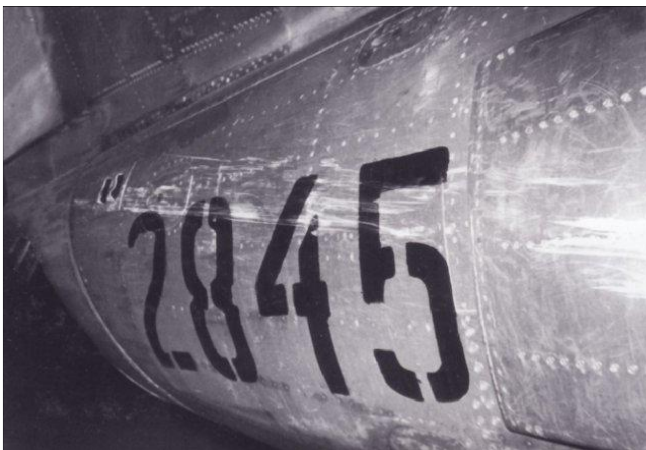
Poškození na Delfínu, pilotovaném Václavem Preslem, způsobené srážkou s rakouským sportovním letounem Scheibe SF-25B Falke 2. září 1973.
