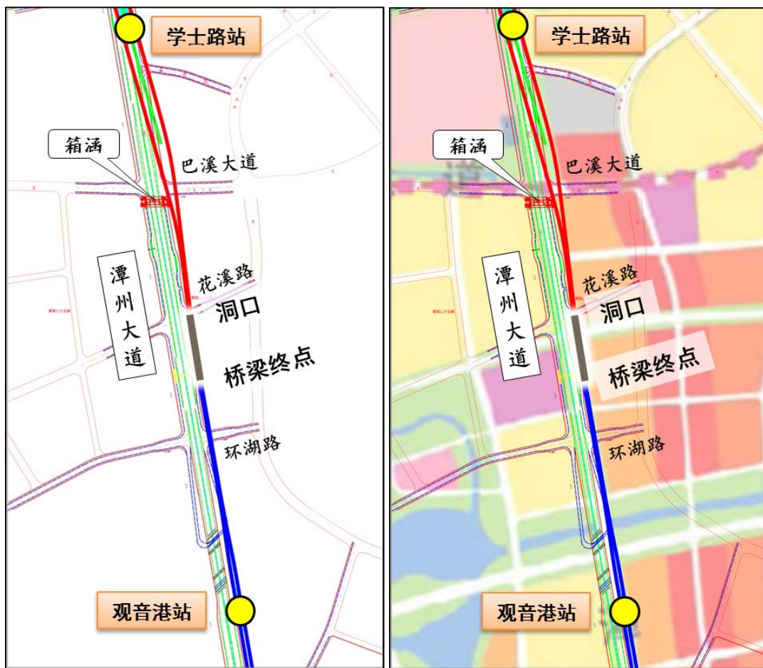
图 2.1-4 观音港站至学士路站平面和过渡段位置示意图
