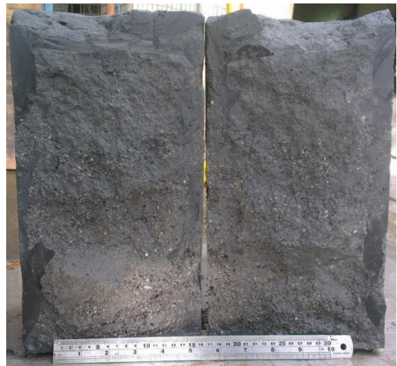
圖 4-3-9 添加特固力 C 之水工模型 試體剖面圖
