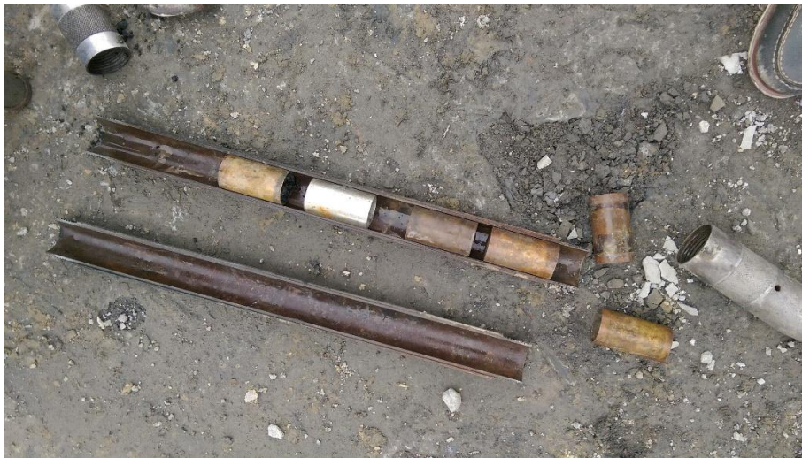
圖 5-3-6 SPT-N 劈管試驗取得之銅圈
