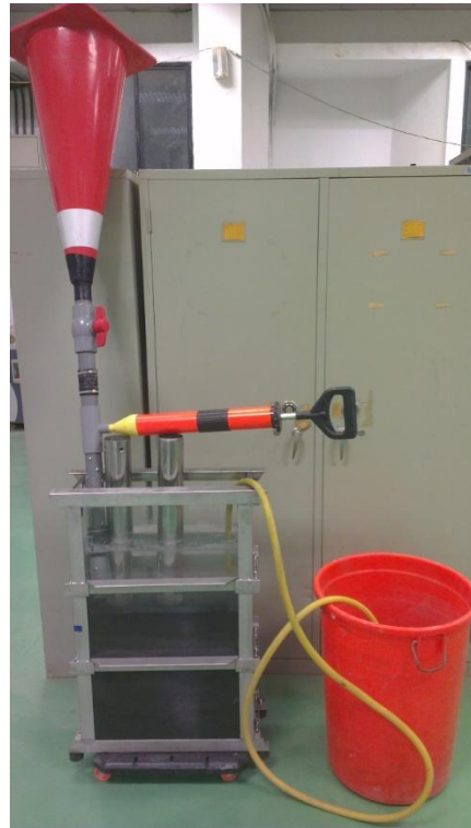
圖 4-2-9 混合管灌注設備照片
