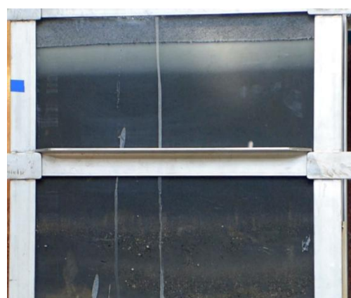
圖 4-3-2 灌注完成後 1 分鐘粒料沉降情形
