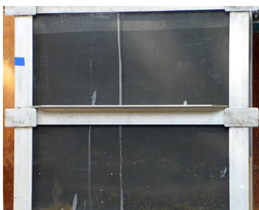
圖 4-3-1 灌注完成粒料沉降情形
