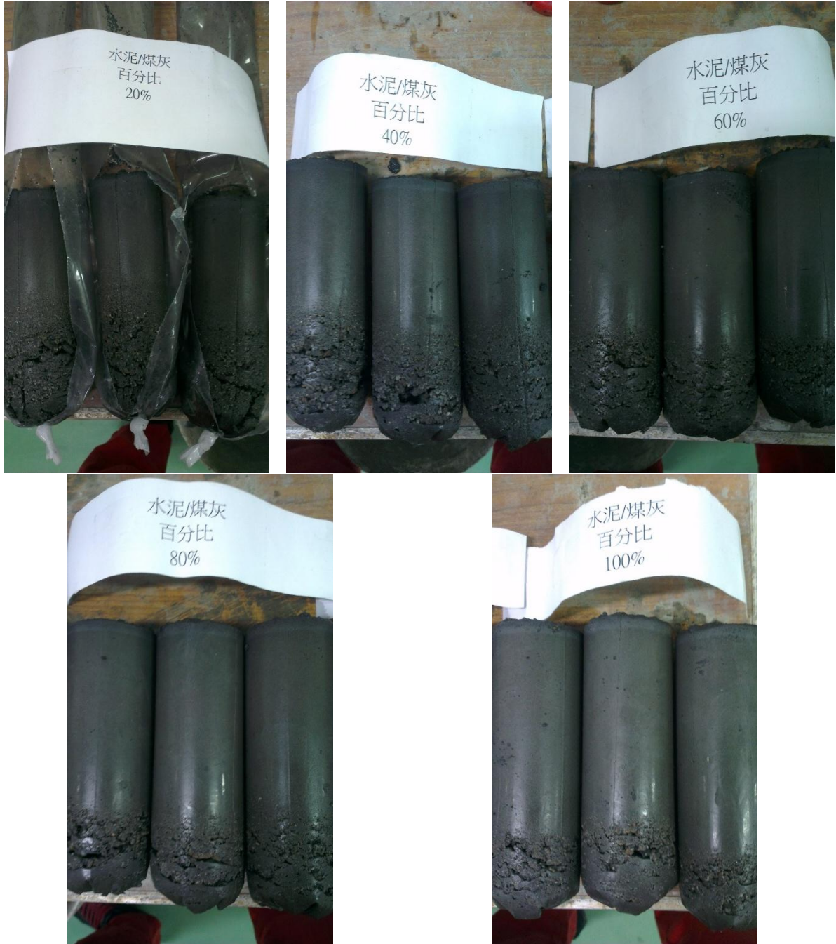
圖 3-2-3 不同水泥比例養護 14 天拆模照片
