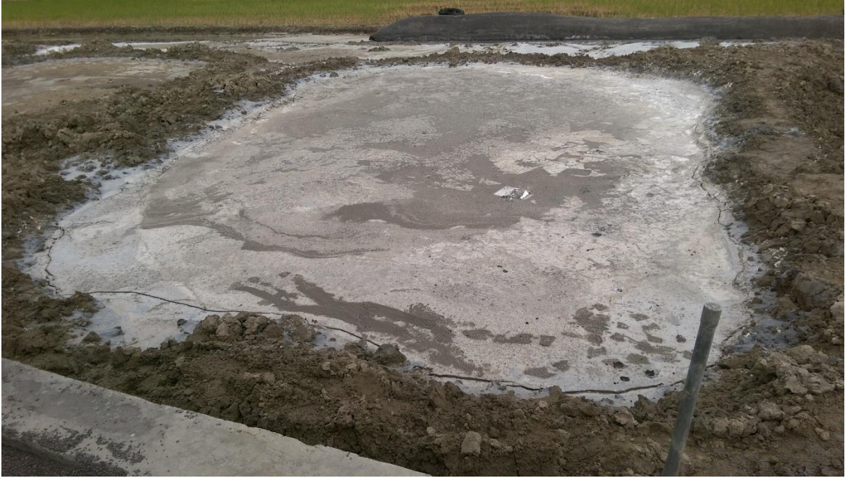
圖 5-1-13 水力回填灌注完成後 28 天狀況(試驗坑 I)
