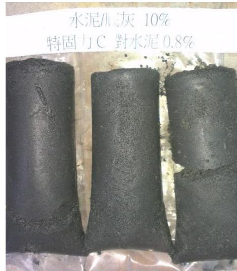
圖 3-3-14 特固力 C 拆模照片
