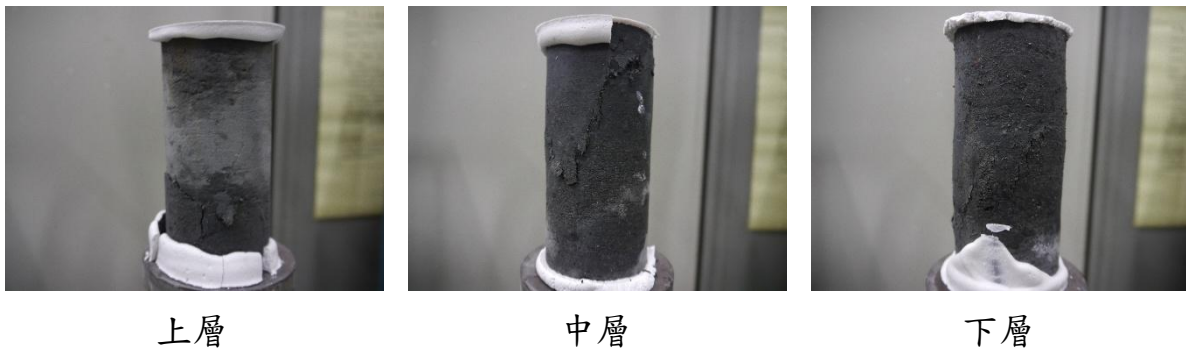
圖 5-3-25 Site2 單壓試體破壞照片
