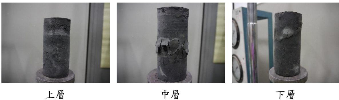
圖 5-3-26 Site3 單壓試體破壞照片
