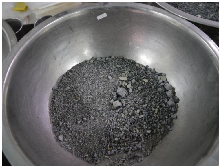
圖 5-3-17 Site2 烘乾後土樣照片
