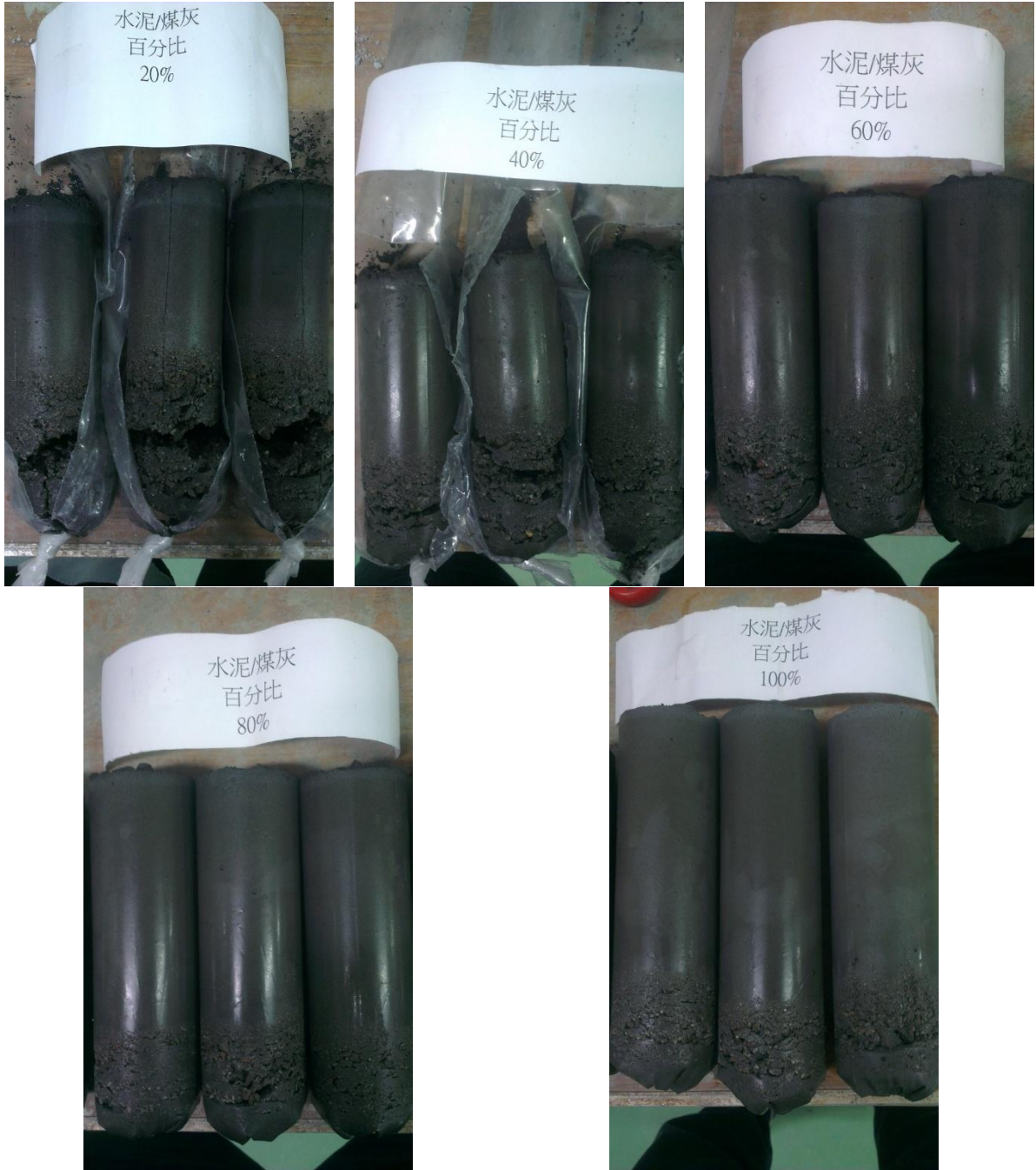
圖 3-2-2 不同水泥比例養護 7 天拆模照片
