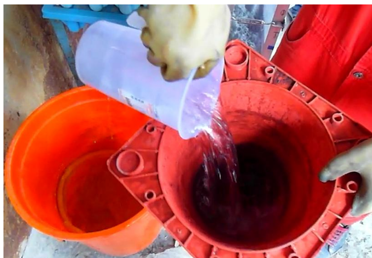
圖 4-2-5 交通錐加入 1 等份底灰的拌合水
