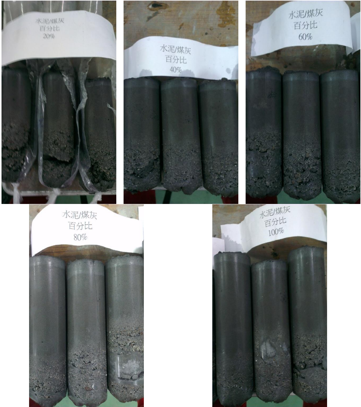
圖 3-2-4 不同水泥比例養護 28 天拆模照片
