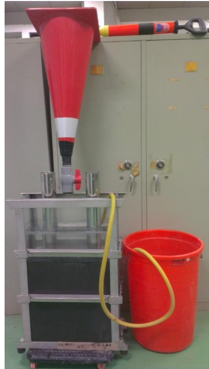
圖 4-3-12 直接灌注設備照片
