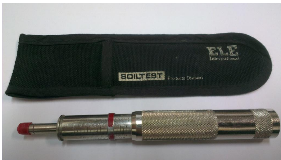
圖 3-4-2 小型土壤灌入儀照片(Pocket Penetrometer)
