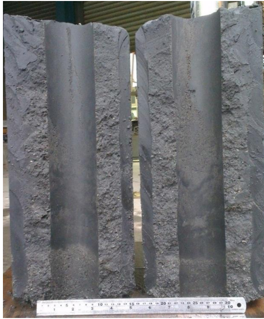
圖 4-3-15 直接灌注之水工試驗試體剖面圖
