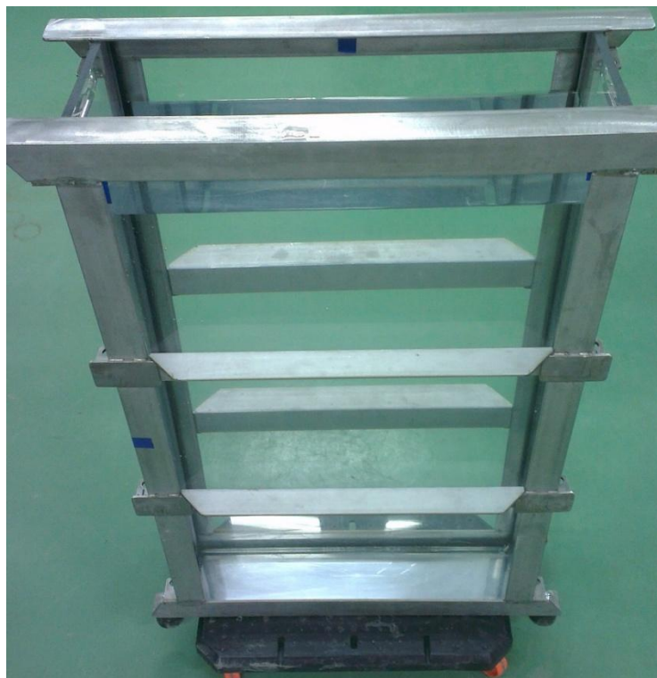
圖 4-1-6 透明壓克力水槽
