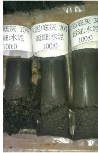
圖 3-3-2 超細水泥養護 28 天照片
