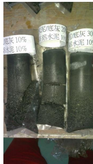
圖 3-3-4 高鋁水泥養護 14 天照片
