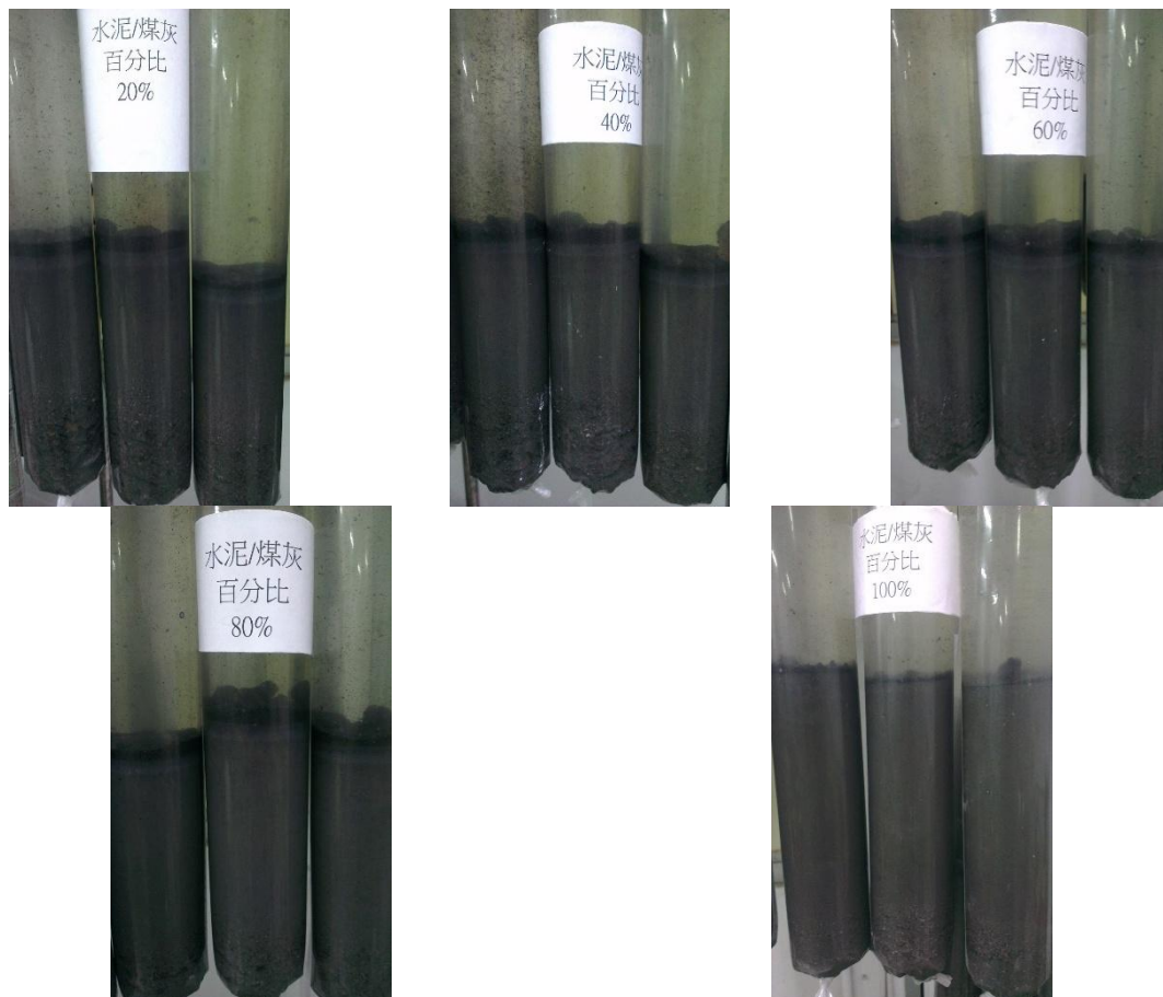
圖 3-2-1 不同水泥比例水中養護照片
