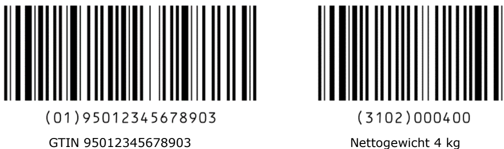
Abbildung 7.8.5.1-1. In zwei GS1-128 Symbolen verschlüsselte Daten
