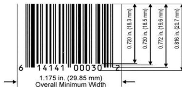
Abbildung 5.10.6.3-1. EAN/UPC Symbol angegeben mit der minimalen Höhe und der Gesamtbreite für eine Vergrößerung von 75% bis 80%
