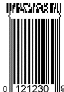
Abbildung 7.8.5.3-2. Beispiel eines Composite Symbols (GTIN im UPC-E, Mindesthaltbarkeitsdatum in der Composite Component verschlüsselt)
