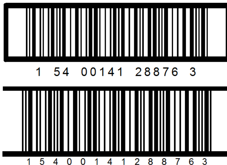
Abbildung 5.3.2.4-1. Beispiele von Trägerbalken
