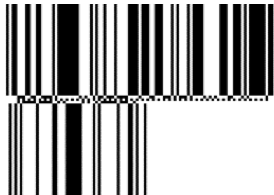
Abbildung 7.8.5.3-1. Beispiel eines GS1 DataBar Expanded Stacked Symbols mit verketteten Daten
