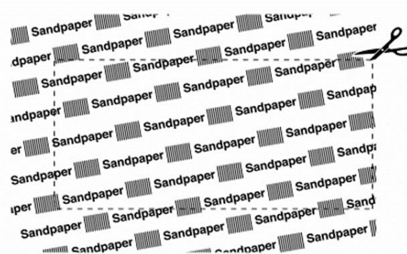
Abbildung 6.3.3.7-2. Symbolplatzierung auf Endlosverpackungen
