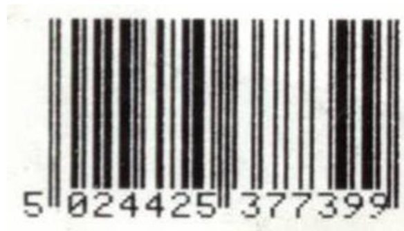
Abbildung 5.10.5.12-1. Symbol mit Problemen bei der Kantenvermessung
