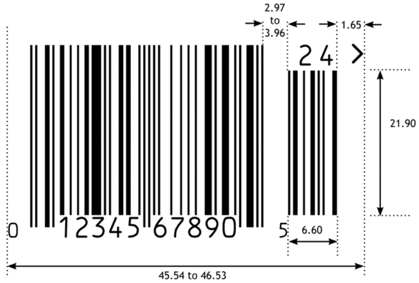
Abbildung 5.2.6.6-5. UPC-A Strichcode mit zweistelligem Zusatzsymbol
