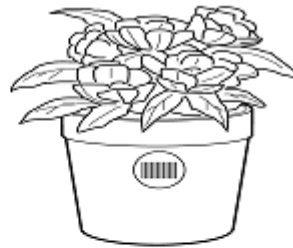
Abbildung 6.2.3.2-1. Symbolplatzierung auf gewölbten Oberflächen
