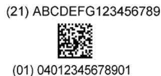
Abbildung 2.6.14-4. Beispiel der Verschlüsselung einer GTIN AI (01) und Seriennummer AI (21) im GS1 DataMatrix
