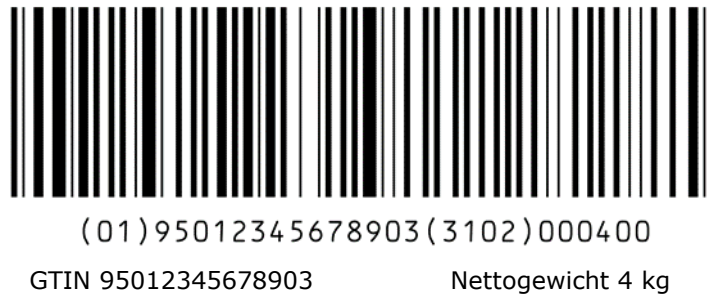
Abbildung 7.8.5.1-2. In einem GS1-128 Symbol verkettete Daten
