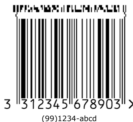
Abbildung 5.9.8-1. EAN-13 Symbol mit einer 4-spaltigen CC-A Komponente
