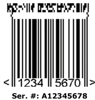
Abbildung 5.9.8-3. EAN-8 Symbol mit einer 3-spaltigen CC-A Komponente
