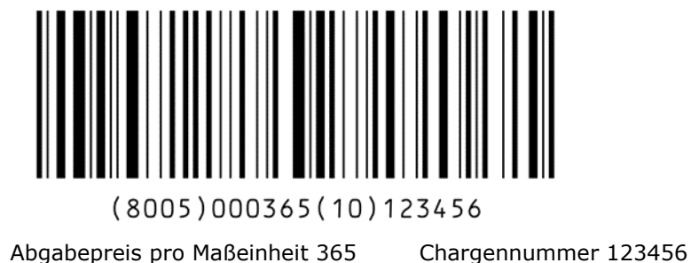
Abbildung 7.8.5.2-2. In einem GS1-128 Symbol verkettete Daten
