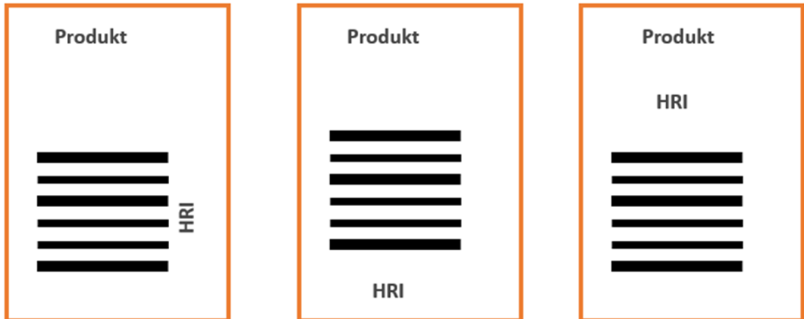
Abbildung 4.15-3. Platzierung der Klarschriftzeile bei Strichcodes in Leiterausrichtung
