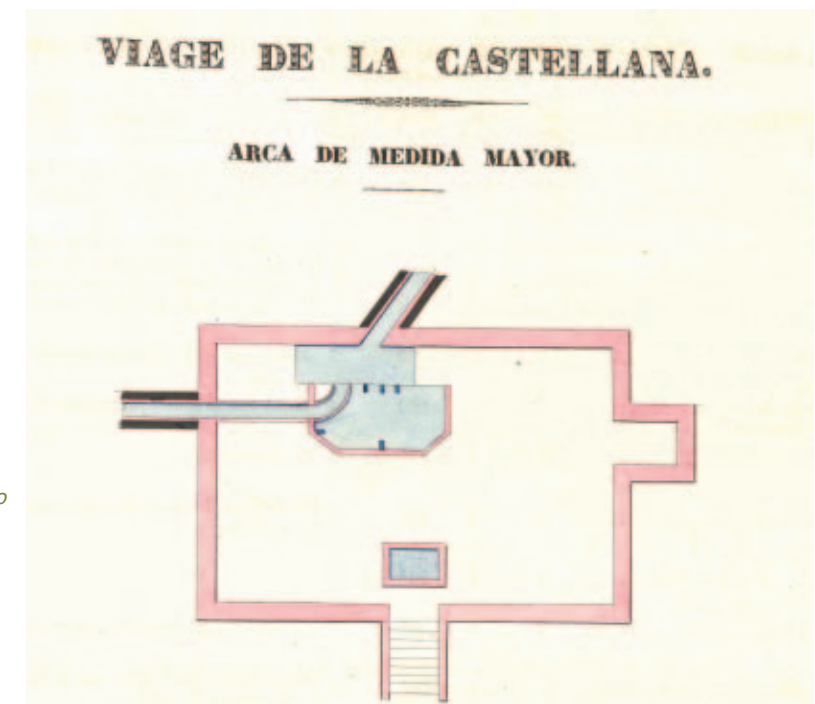
Viaje de agua de la Castellana. Arca de medida mayor, sección. Ayuntamiento de Madrid, Cuaderno de distribución de las aguas potables de los viajes Alto y Bajo Abroñigal, Castellana y Alcubilla de la M.H. Villa de Madrid. Madrid, Imprenta de Eusebio Aguado, 1836, p. 55.
