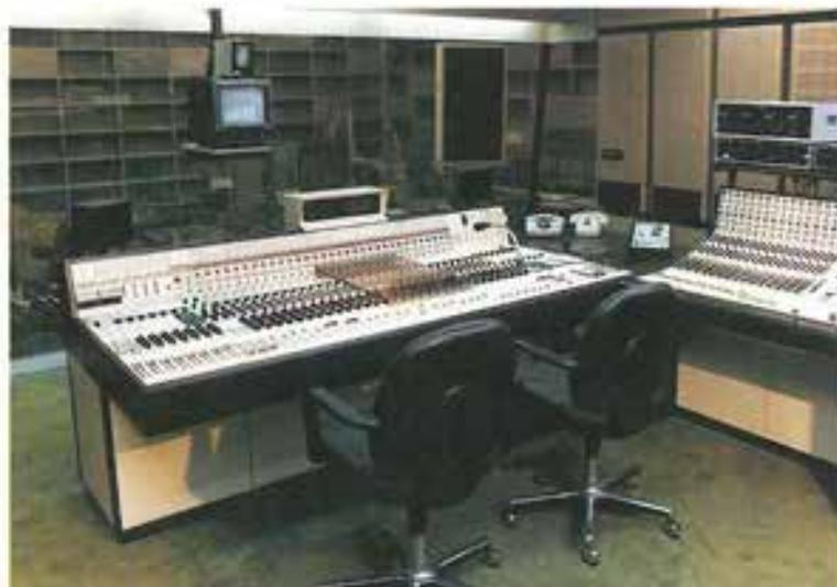
Die neue Produktionsregie 1 besitzt neben dem Mischpult mit 64 Eingängen auch eine Anzahl hochwertiger und moderner Zusatzgeräte wie digitalen Hall, Multikanal-Aussteuerungsanzeige und Audio Analyzer. Sie entspricht damit allen Anforderungen, die heute an eine moderne Tonproduktion gestellt werden.
