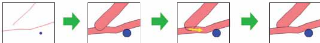
Obr. 3.2e Převedení vrstev bodových a liniových segmentů na polygony (buffer)
