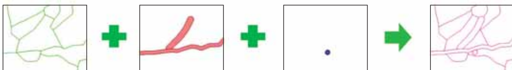
Obr. 3.2f Sloučení dílčích vrstev do jediné liniové vrstvy
