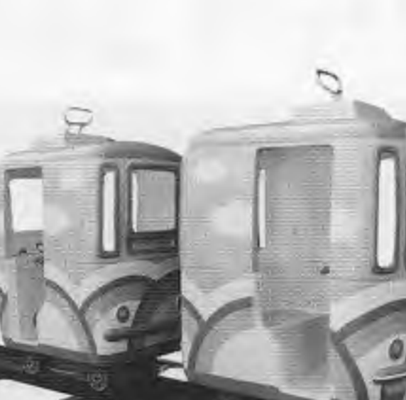
レインボー レール走行式乗物機。2両編成の電車がレール上を前後進し往復するスイッチバック方式。4人乗り。16mレールの標準セット定価290万円。【ホープ】No374
