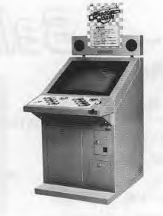
ステイタス 18 ミディ型TVゲーム機キャビネット。ブラウン管の縦横変換、基板、操作盤入れ替えなどメンテナンスは前面で可能。OP価格18万8千円。【カプコン】No372
