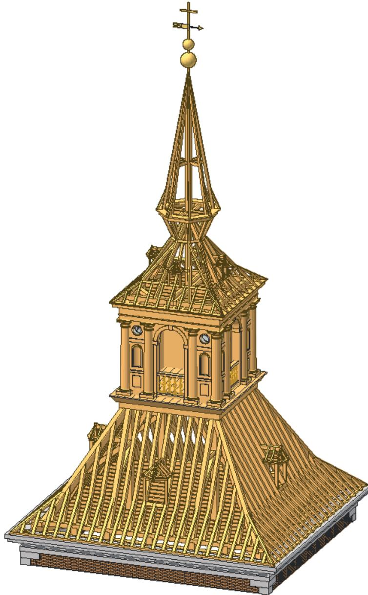
Fig. 152. Idem anterior. armadura del chapitel terminada según el autor
