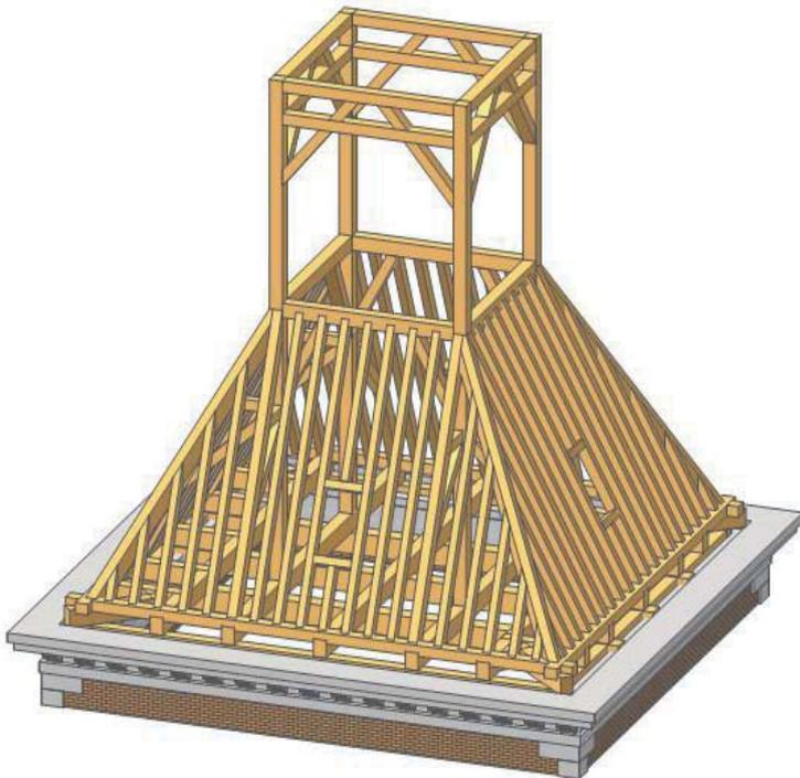
Fig. 146. Idem anterior Armado de los faldones bajos según el autor
