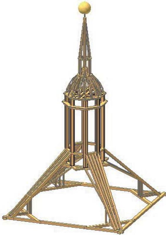
Fig. 164. Sistema de apoyo de la linterna ochavada del chapitel de las Góngoras en Madrid construido sobre 1670 D.A.
