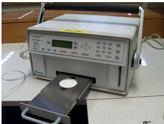
Portabelt instrument for måling av alfa- og betastråling fra prøvemateriale.
