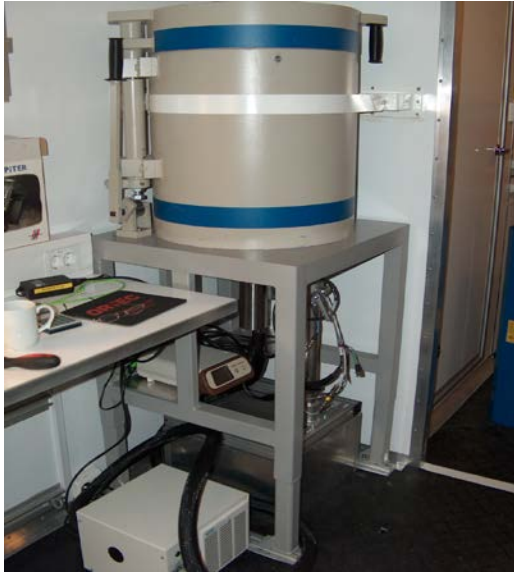
Instrument for gammamålinger montert i blyskjerming.
