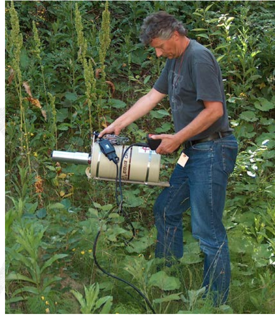
Portabel høyoppløselig gammadetektor for bruk i felt.
