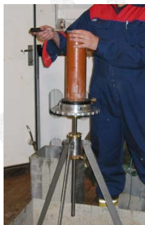
Utstyr for prøvetaking av jord og sedimenter (venstre) og portabel luftsuger for måling av luftbåren radioaktiv forurensning (høyre).
