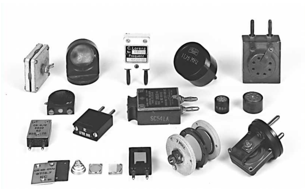
Abb. 1.4 Quarze im Luftspalhalter, in Kunststoff- oder Keramikgehäusen
