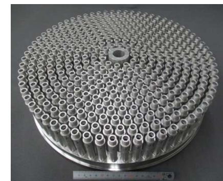
3D造形製造法の一例 (LE-9噴射器エレメント)
