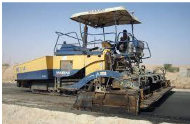
Σχήμα 2.6: Αριστερά: αυτοκινούμενος διανομέας ασφάλτου ( federal ), Δεξιά: διαστρωτήρας ασφάλτου ( finisher ).
