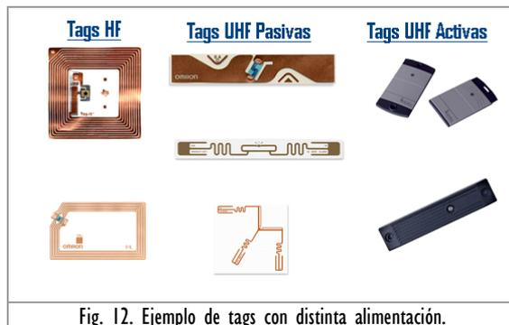
Fig. 12. Ejemplo de tags con distinta alimentación.
