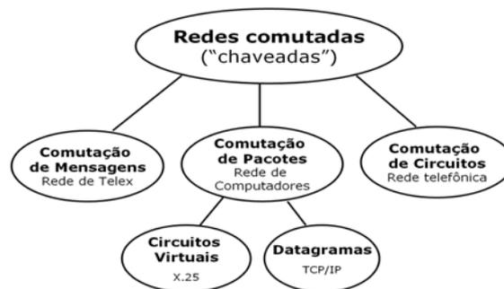
**Figura 1.** Tipos de comutação de rede
