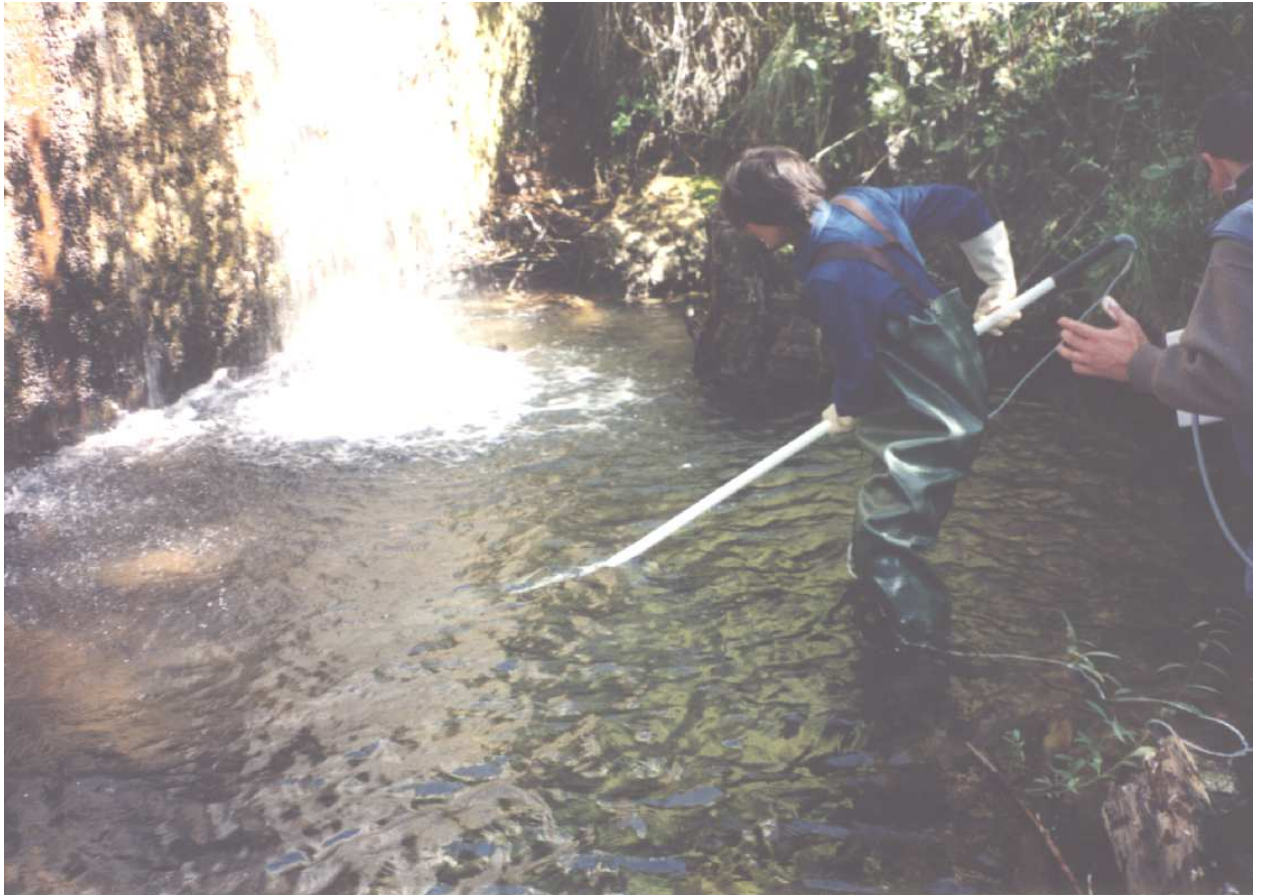
Campionamento con elettroscandaglio (fiume Agri). Foto Caricato L.
