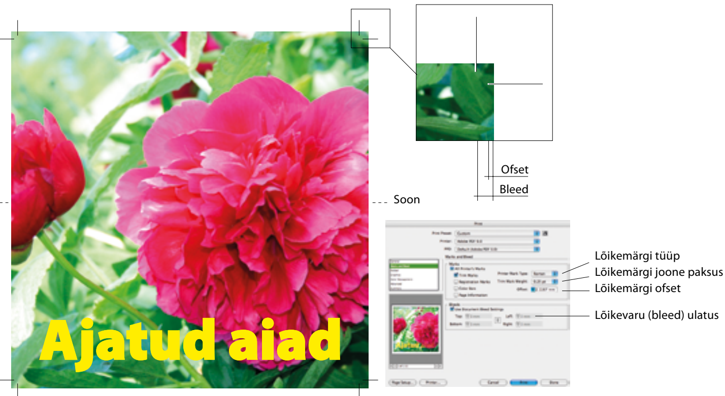
Joonis 17: Lõikemärkide ja lõikevaru määramine
