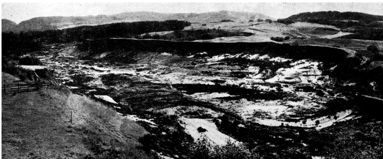
Obr. 8.33 Letecký snímek sesuvu v senzitivních jílech u Skjelstadmarku v Norsku r. 1962. (Foto NGI. In Q. Záruba – V. Mencl, 1974)
