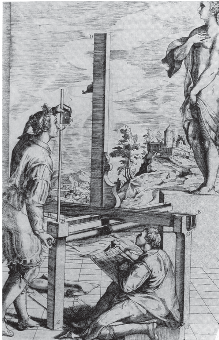
Artist viewing through a pinhole fixed eye point in a perspective machine. From Jacopo Barozzi di Vignola, Le Due regole della prospettiva pratica , edited by Ignatio Danti, Rome, 1583.
