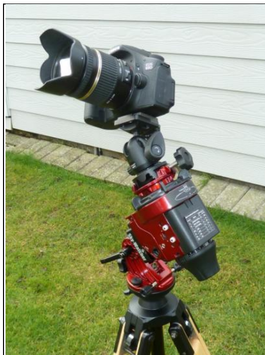
Foto 2/19: De Skywatcher Star Adventurer, een krachtig en compact systeem, er is intussen een nog kleinere versie van deze tracker, de Star Adventurere Mini die via een smartphone of tablet en WiFi te bedienen is.
