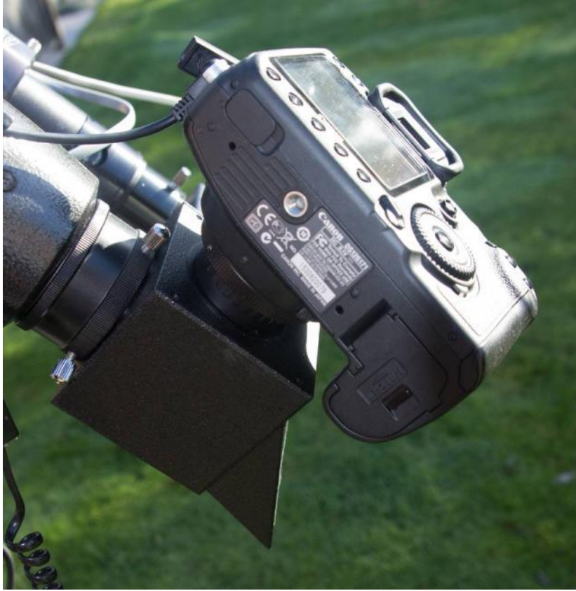
Foto 4/6: Een Canon DSLR op een Baader Planetarium Herschel-wig. Dit is het type dat verkocht werd voor de versie met keramisch venster werd uitgebracht. Opname: Geert Vandenbulcke.
