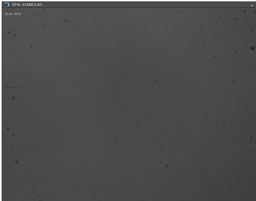
Foto 5/28: Een flatfield-opname (vlakopname) toont dat stof beter. Opname: Geert Vandenbulcke.
