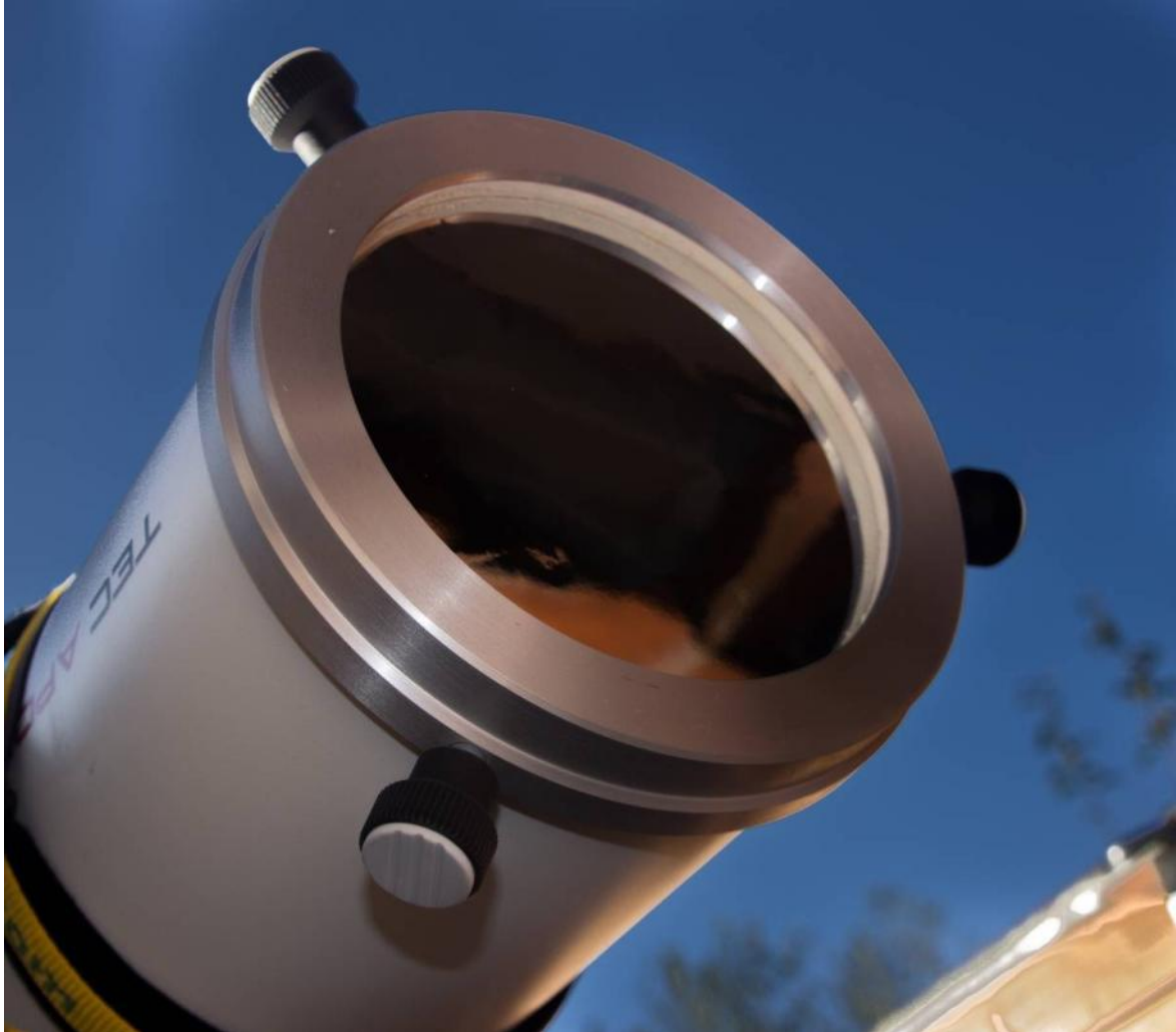
Foto 4/4: Een AstroSolar folie in een aluminium vating vooraan op een refractor. Als je zelf een vating maakt voor een folie-filter kan het zijn dat er wat rimpeltjes in zitten, dat kan helemaal geen kwaad zolang er maar geen gaatjes of scheurtjes in zitten. Opname: Geert Vandenbulcke.
