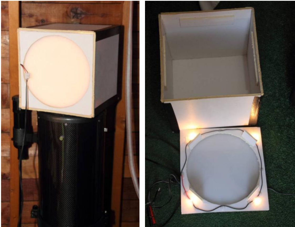
Foto 5/34: Hierboven zie je een zelfbouw-flat-field-box, gemaakt met foam board. Je zet dit met het verlicht oppervlak op de kijker om de vlakbeelden te maken. Rechts zie je het ondervlak waarin twee stukken opaal plexiglas zitten, op ongeveer een cm van elkaar. In de vier hoekjes zitten 3V lampjes in serie verbonden. De draadjes zijn vastgelijmd. De lampjes zitten achter een verticaal scherm zodat er geen licht rechtstreeks op het plexiglas schijnt. Het licht van de lampjes wordt in de doos met witte binnenkant egaal gereflecteerd. Dit werkt op een 230V-AC-adapter die 3-6-9 en 12V DC geeft. Met die instellingen kan de helderheid van de lampjes geregeld worden. Een 12V- of 9V-batterij is natuurlijk ook mogelijk. Opname: Geert Vandenbulcke.
