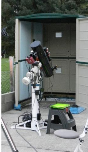
Foto 5/19: Een in de handel verkrijgbare berging voor de tuin werd omgebouwd tot een verrijdbaar systeem dat over de telescoopopstelling kan gereden worden. Let wel even op dat alles goed vastgezet kan worden, zodat het een storm kan weerstaan! Opname: Mario Jammers.
