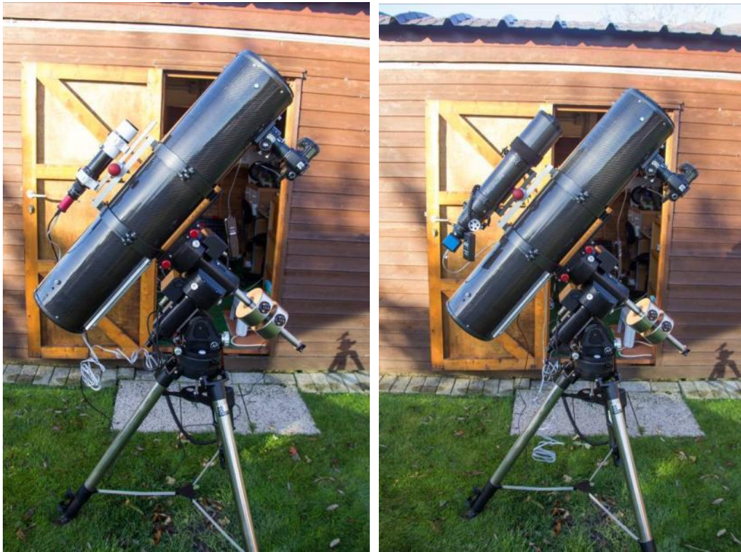
Foto 5/6: Een newton kijker, links met een kleine Borg-refractor en SBIG-STi-volcamera. Rechts met een 80mm-refractor en DMK-camera om te volgen. Opnames: Geert Vandenbulcke.
