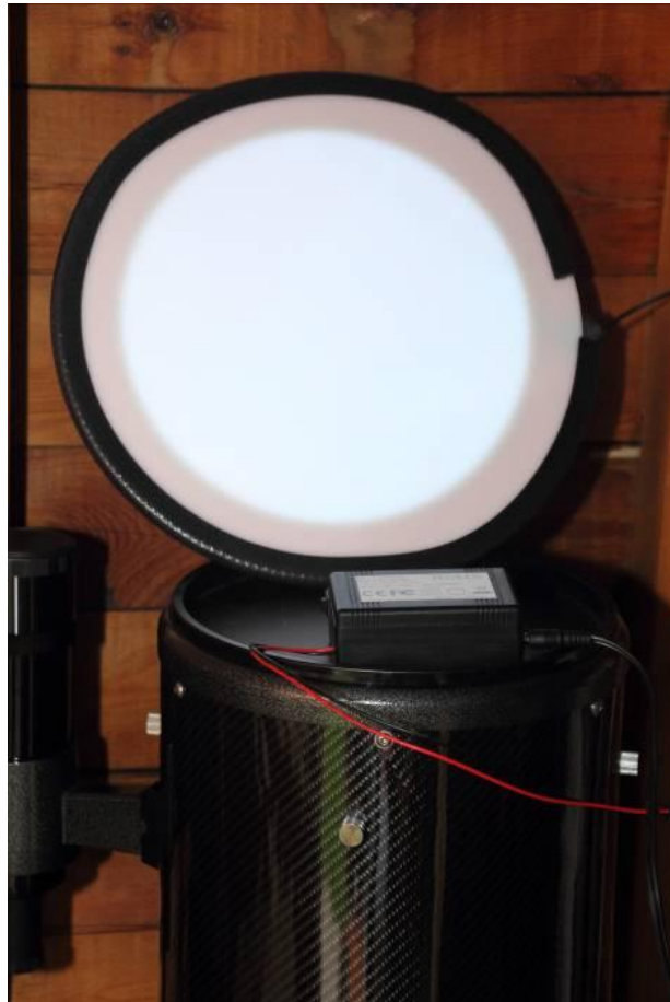
Foto 5/33: Een Gerd Neumann Aurora Flat Field paneel met de voeding er voor. Je legt dit paneel met het verlicht oppervlak op de kijker om de vlakbeelden te maken. Opname: Geert Vandenbulcke.
