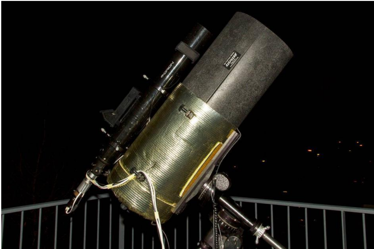
Foto 5/11: Een Celestron 11 SCT op een Losmandy G11 montering. Bemerkt de refractor als volgkijker met volgcamera en de lange dauwkap. De kijkerbuis is ook ingepakt in een isolatiemantel om een te snelle afkoeling tegen te gaan. Opname: Michael van Doorn.
