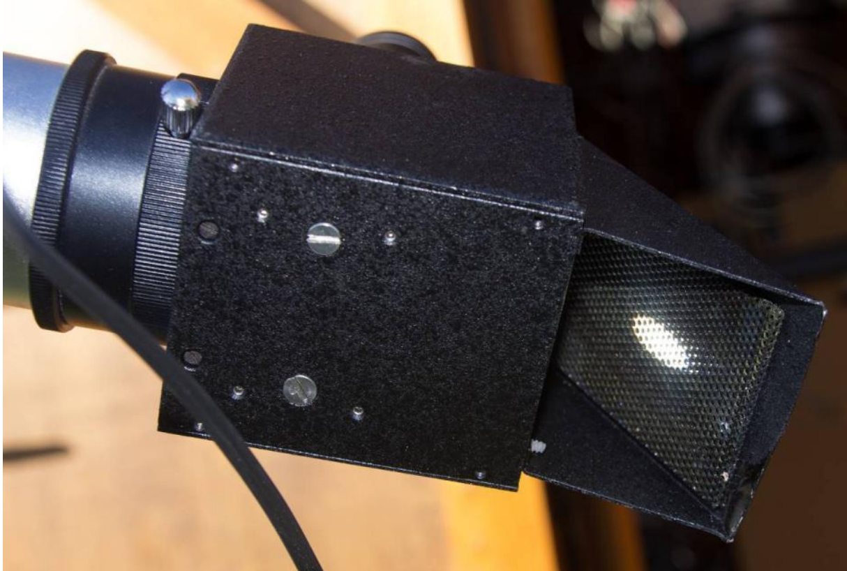
Foto 4/7: Bij sommige Herschel-wiggen wordt het licht naar buiten weerkaatst door een spiegel en kan zo nog verbranding veroorzaken van voorwerpen die in het zonnelicht komen. Hier wordt het warme zonnebeeld opgevangen door een rooster. Opname: Geert Vandenbulcke.
