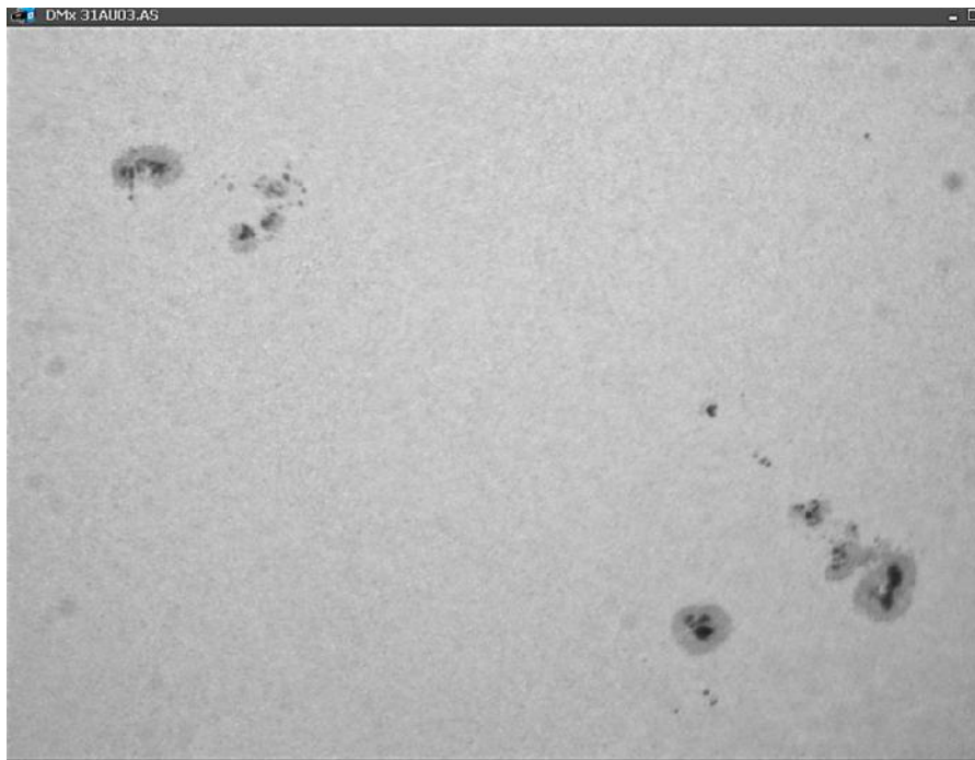
Foto 5/27: Op het beeld van de Zon zien we naast de echte zonnevlekken ook licht onscherpe vlekjes veroorzaakt door stof op het afdekplaatje van de sensor. Opname: Geert Vandenbulcke.
