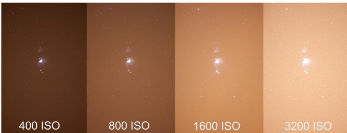
Foto 5/1: Vier opnamen van de Orion-nevel met een Canon EOS 5D MkII en een 300 mm-telelens. De ISO-waarden zijn vermeld, de belichting bedroeg steeds 2 minuten. Opname: Geert Vandenbulcke.
