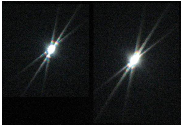
Foto 5/15: DiffRACTIE bij gebruik van een Bahtinov-masker.
