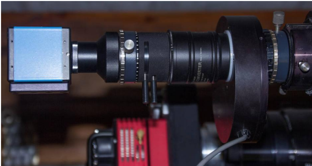
Foto 4/31: Van rechts naar links zie je een filterwiel, een FFC barlow, een ADC, een camera-adapter en een DMK-camera. Dit is een opstelling voor planeetfotografie. De ADC kan vervangen worden door een gewone verlenghuls zodat de vergroting gelijk blijft. Opname: Geert Vandenbulcke.
