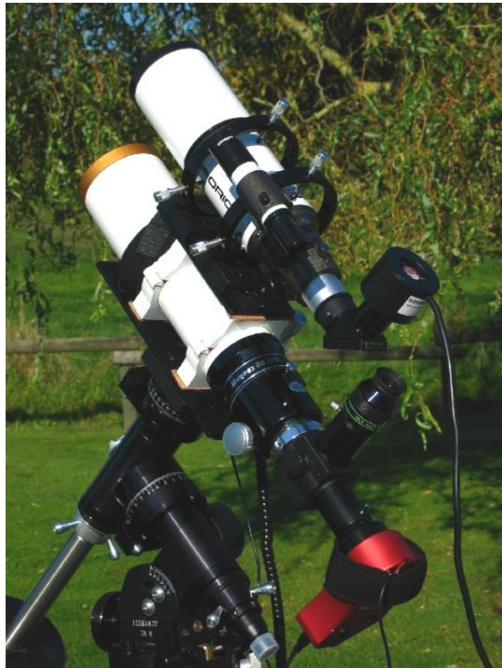
Foto 5/7: Een 80mm-refractor met piggy-back-volgkijker in verstelbare ringen. In de volgkijker zit een CCD-camera voor het volgen, op de 80mm kijker de ATIK CCD-camera om opnamen te maken. Voor de
