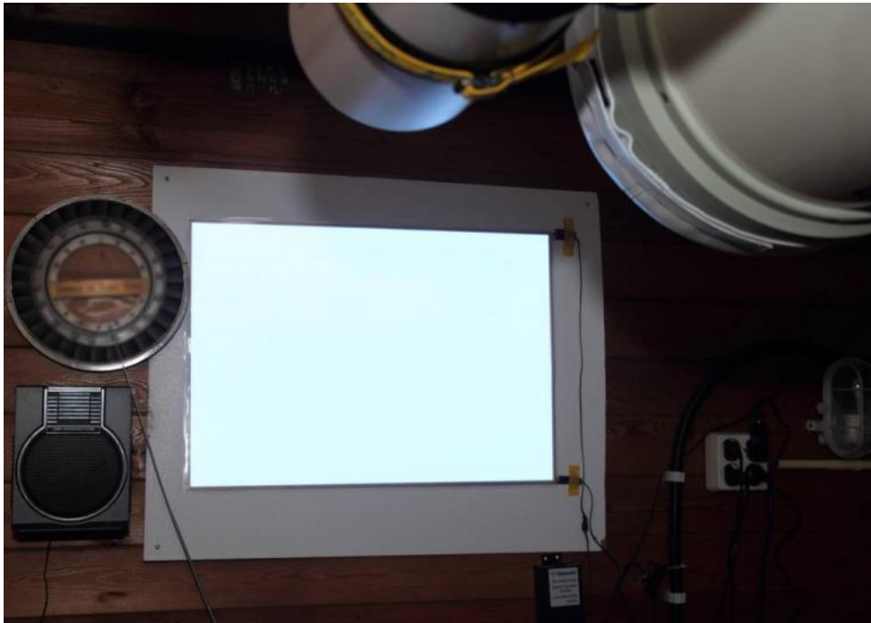
Foto 5/32: Een groot vel flat-field-folie tegen de muur van mijn sterrenwacht. Onderaan rechts de specifieke voeding er voor. Op de telescoop komt ook nog een opaal plexiglazen plaat wanneer de vlakbeelden gemaakt worden. Opname: Geert Vandenbulcke.
