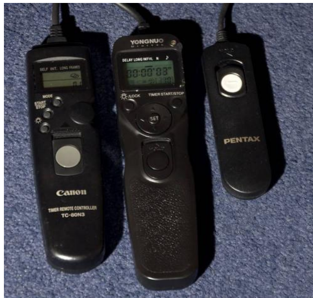
Foto 2/1: Drie soorten afstandsbedieningen, links de originele programmeerbare Canon TC80-N3, in het midden een Chinese versie van Yongnuo en rechts een eenvoudige handbediende afstandsbediening van Pentax. Er bestaan ook afstandsbedieningen die met infrarood werken i.p.v. een kabel maar die zijn meer geschikt voor gewone fotografie wanneer je zelf in beeld staat. Opname: Geert Vandenbulcke
