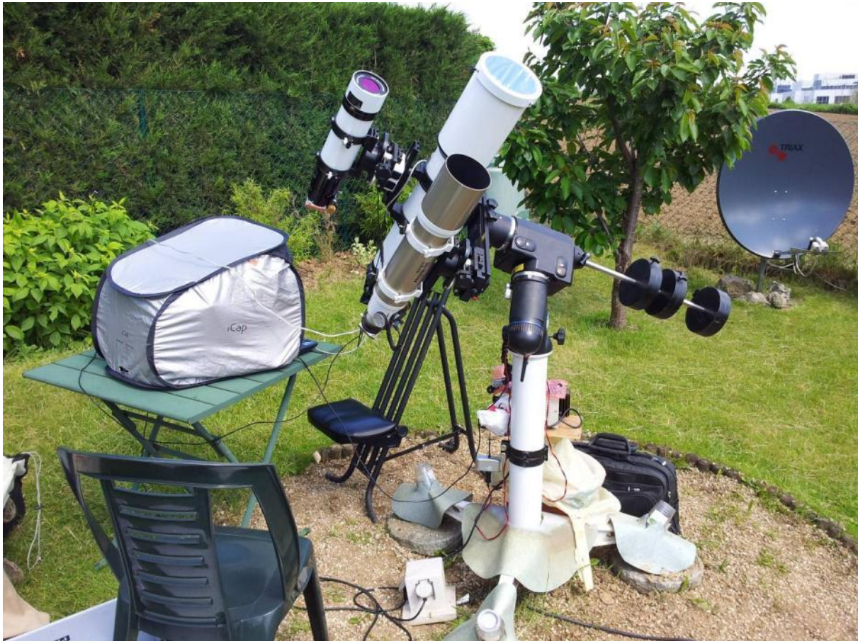
Foto 4/9: De laptop staat in een iCap-tentje bij de montering. De gewone refractor heeft een folie zonnfilter en piggyback is een H-alfa-zonnekijker gemonteerd. Opname: Janos Barabas.
