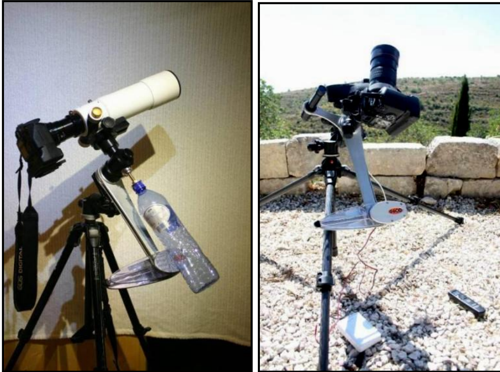
Foto 2/18: De Astrotrac, gebaseerd op het volgplankje is een lichtgewicht en toch zeer nauwkeurig volgsysteem voor astrofotografie. Bemerkt op de linkeropname de gevulde waterfles als tegengewicht voor de kleine kijker! Opnames van Philippe Mollet.
