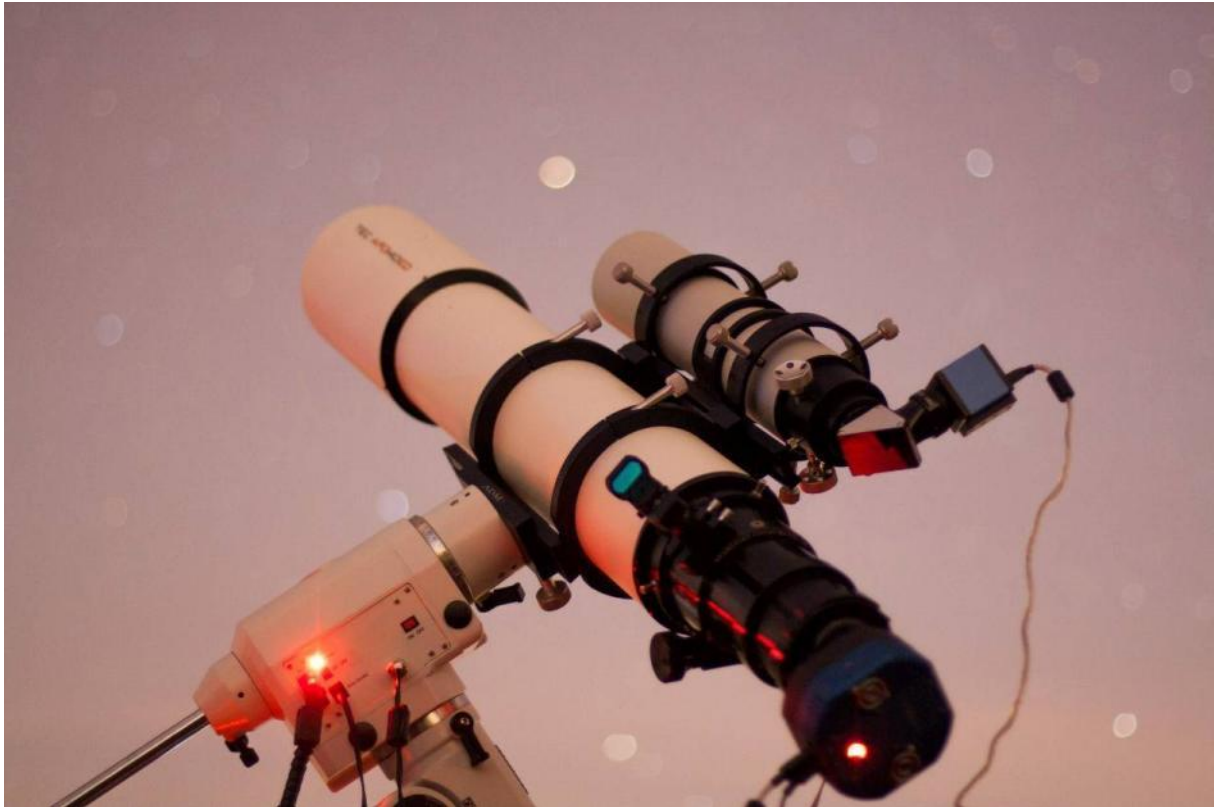
Foto 5/8: Een TEC140-refractor met een volgjijker op een EQ6-montering. De volgjijker zit ook hier in verstelbare ringen en een DMK-webcam wordt gebruikt als volg camera. Het zou beter zijn dat de kabels aan de telescoop vastgemaakt worden. Opname: André Vanderhoeven.
