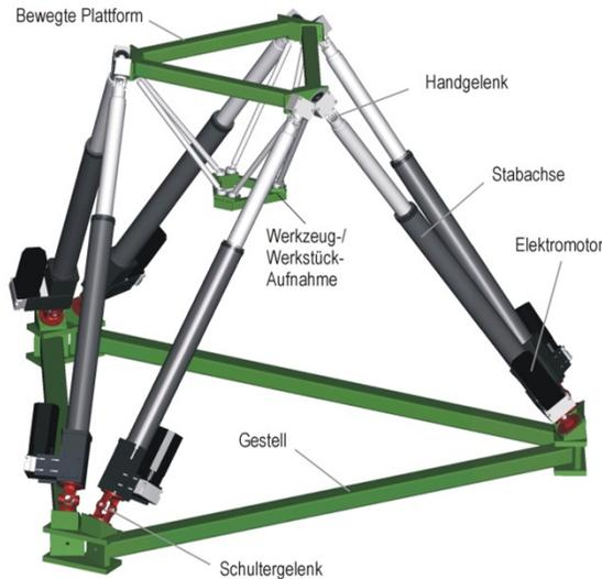
Einfaches kinematisches Modell
