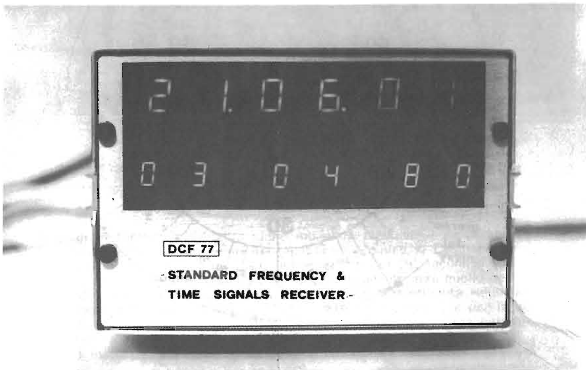
La versione, per così dire, « maxi » del « DCF 77 » Standard Frequency e Time Signals Receiver. In questa versione non sono compresi i visualizzatori dei giorni della settimana.
