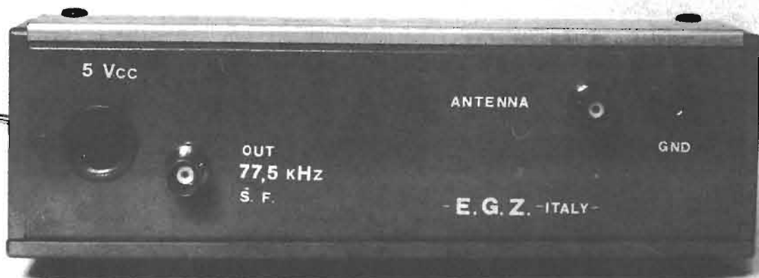
Vista posteriore del « DCF 77 », Standard Frequency e Time Signals Receiver. È visibile sul lato sinistro la levetta del comando di « blanking » per spegnere o accendere il display.
