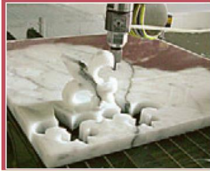
Şekil 15 Waterjet ile Mermerin Kesilmesi
