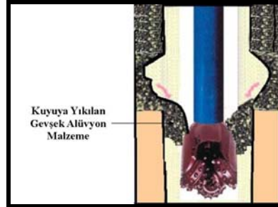
Şekil 1. Kuyu genişlemesi nedeni ile kuyuda dolgu oluşumu, (Özdemir,2007)
