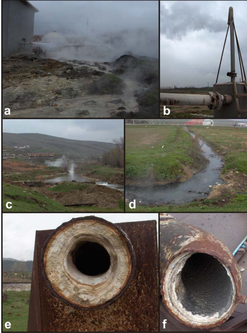
Şekil 4. (a-d) Afyonkarahisar ili Ömer-Gecek jeotermal alanda kullanılan ve kullanılmadan çevreye ve Akarçay'a verilen jeotermal suyu ve gaz emisyonları. (e), (f) Jeotermal kuyularda ve dağıtım sisteminde kullanılan boru ve kazanlarda meydana gelen kabuklaşma ve çökeltme olayına örnek fotoğraflar
