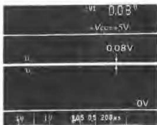
照片 11.12 使用双管时的集电极电位(1V/div, 200 $\mu$ s/div)
