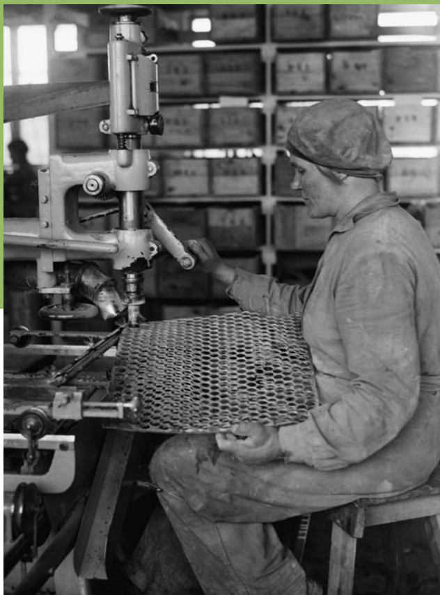
Kovettuneista kaseiinilevyistä irrotettiin nappiähiöt ulosporauskoneella. Kuva: V. O. Kanninen, 1930-luku, Tampereen museot.
