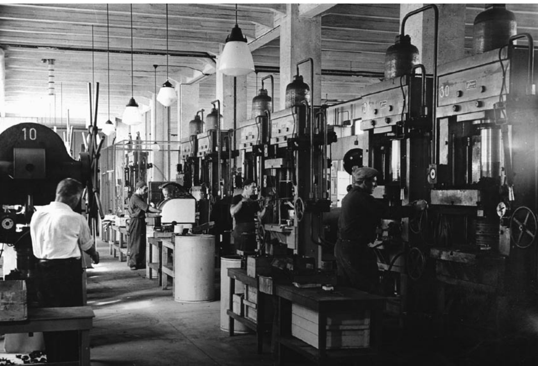
Osa kertamuovipuristamoa vuodelta 1958. Suurimpien hydraulisten puristimien puristusteho oli 250 tonnia, mutta pienempien tuotteiden valmistuksessa käytettiin vielä myös käsikäyttöisiä mekaanisia puristimia. Kuva: Muoviyhdistys.
