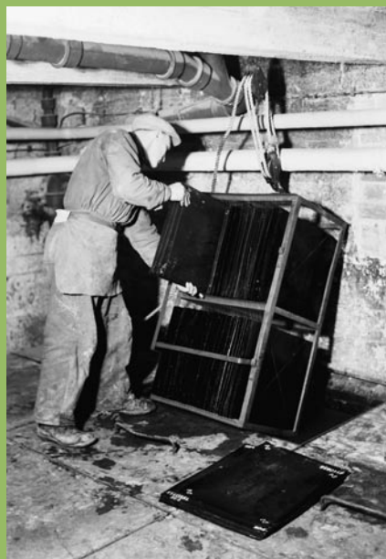
Raaka-ainepalat muokattiin levyiksi hydraulisisissa puristimissa erityisten teräslevyjen välissä (äärimmäisenä vasemmalla). Puristetut kaseiinilevyt kovetettiin luumaisiksi formaliiniliuosaltaisissa. Levyjen paksuus määräsi liotusajan (vasemmalla). Kuvat: V. O. Kanninen, 1930-luku, Tampereen museot.
