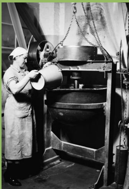
Kaseiinimuovin aineosat eli väriaineet, kaseiinijauho, vesi ja pehmitteet kaadettiin raaka-aineen sekoituskoneeseen (vasemmalla). Kaseiinimassasta valmistettiin tankopuristuskoneessa taikina- mainen tanko, joka leikattiin paloiksi (alla). Kuvat: V. O. Kanninen, 1930-luku, Tampereen museot.
