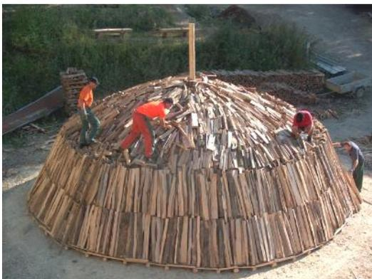
Jetzt kann das Holz aufgeschichtet werden. Ein erster Ring von aufrecht stehenden Spalten wird ums Füllihus gestellt. Es folgen weitere Stockwerke. Am Schluss erreicht ein Meiler eine Höhe von drei bis vier Metern.
