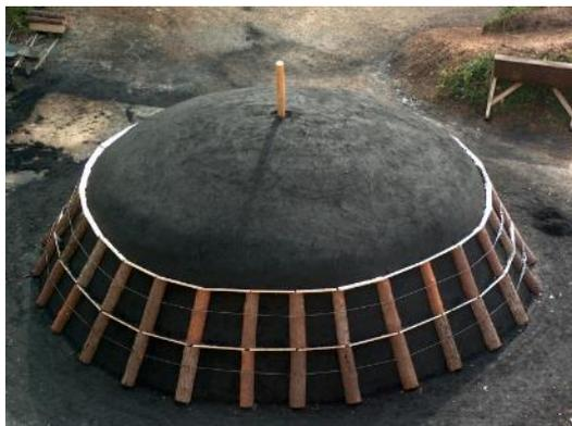
Zur Sicherung des Meilers werden in Abständen von einem Meter Spalten an die Meilerwand gestellt und die unteren zwei Stockwerke mit Drahtweilen zusammengebunden.
