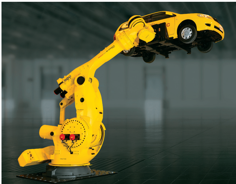
大ロボット M-2000iA/1700L の完成車体搬送
