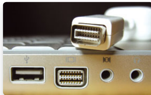
◀ Apple kulkee omia polkujaan: mini- (kuvasassa) ja micro-dvi:t ovat yleisimmän käytössä Mac-kannettavissa.
