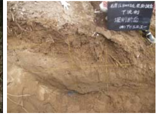
掘削断面写真 穴(石膏)は表土層にのみ確認
