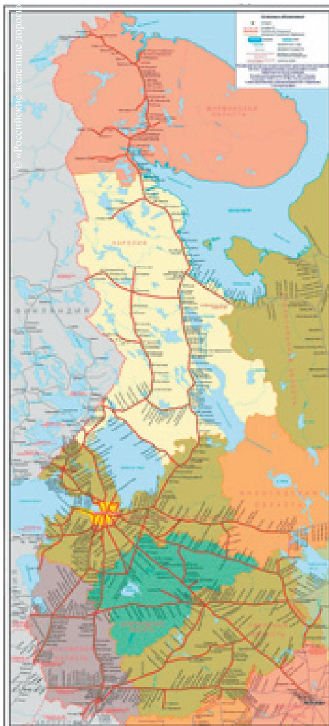
**Рисунок 4.4** Октябрьская железная дорога проходит из Москвы в Санкт-Петербург, на север по Республике Карелия в Мурманск, и далее на запад в Никель, расположенный на границе с Норвегией. Она имеет эксплуатационную длину 10 143 километров и по ней перевозится более 100 миллионов тонн грузов в год. По Октябрьской железной дороге доставляется экспортная нефть в порты Витино и Мурманск.
