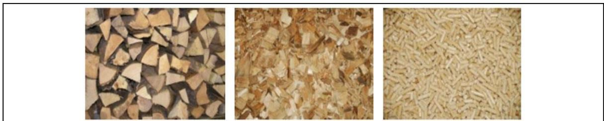
**Abbildung 3: Holzbrennstoffe Stückholz, Hackschnitzel und Pellets (Quelle: [2])**
