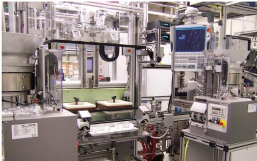
Linieninstallation eine PS48-16 BlueWave EMPT Anlage. Auslegung für 2.000.000 Bauteile pro Jahr im 3- Schichtbetrieb
