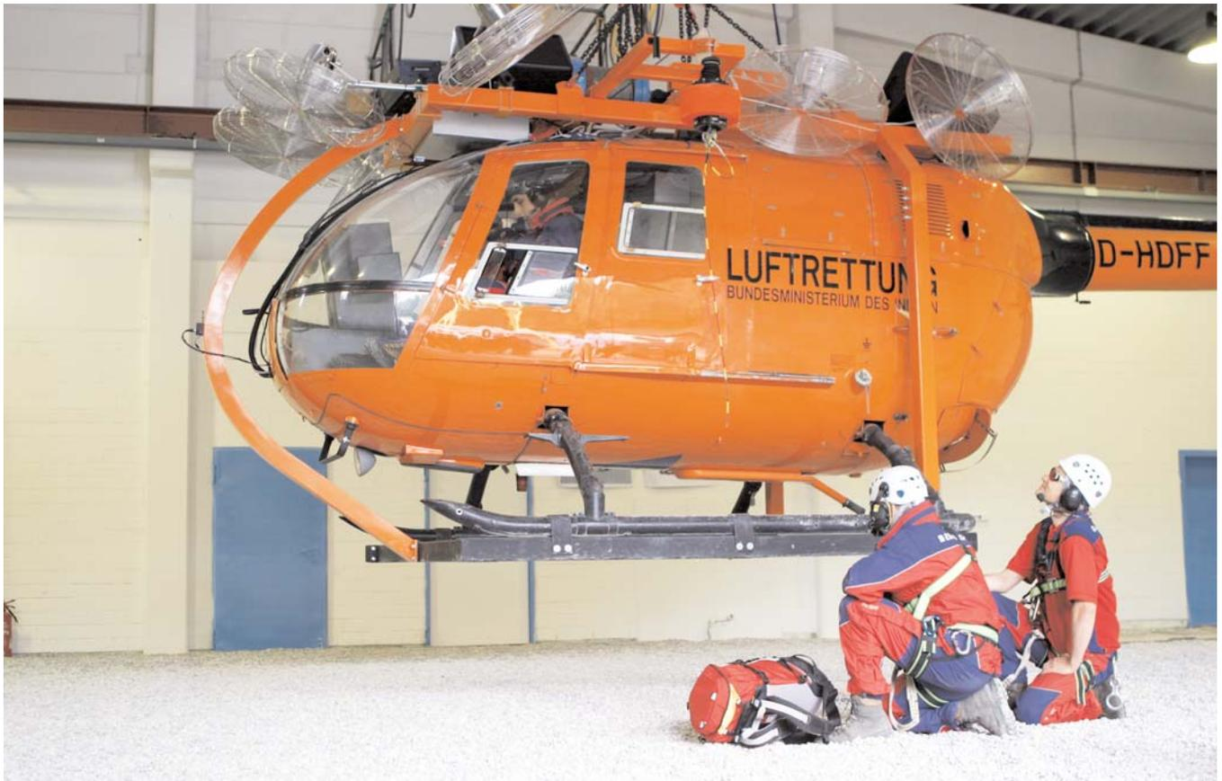
In einer umfassenden Testreihe wurde an mehreren Autokränen erprobt, in welcher Höhe die optimalen Trainingsbedingungen herrschen. Es wurden mindestens 12 Meter Höhe unter der Kufe benötigt, um die erforderlichen Übungssituationen aufbauen zu können. Somit ergab sich, bei einer Hubschrauber- und Konstruktionshöhe der Krananlage von jeweils etwa vier Metern, eine erforderliche Hallenhöhe von ca. 20 Metern.
