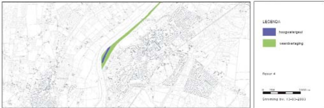
Figuur 4 Kaart van de ingrepen die mogelijk zijn in het winterbed bij Steijl om de waterstand te verlagen.
