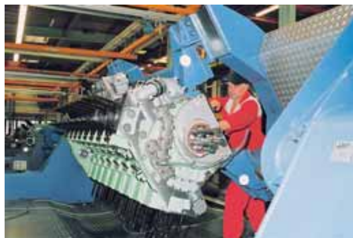
Durch die neue Fließfertigung bei der Baureihe 620 konnten wir die Montagekapazität in 2001 deutlich steigern und gleichzeitig den Arbeitsaufwand um 30% senken.
