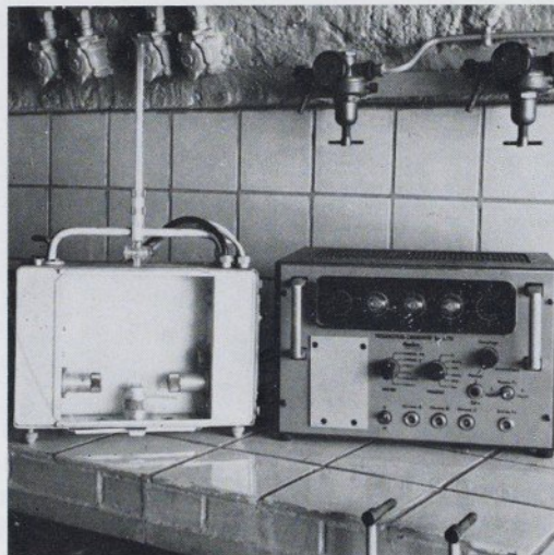
Test d'allumage « goutte à goutte » des propergols liquides.
