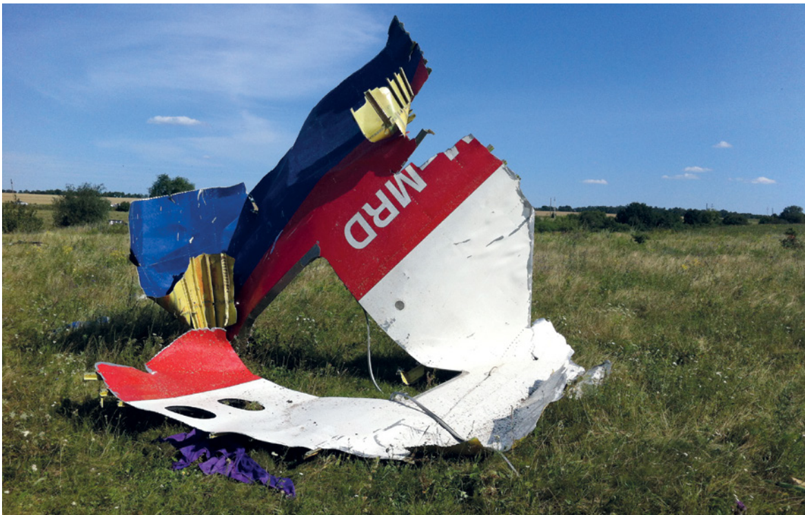
Figuur 13: Rechterdeel van de huid van de achterste rompsectie, met deel van de vliegtuigregistratie. (Bron: NBAAI).
