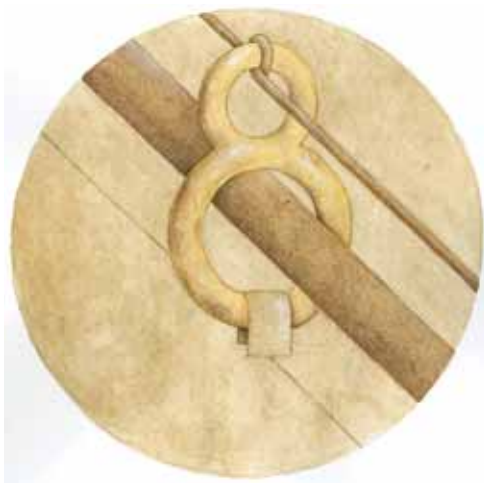
Fig. 30. Particolare del modo di utilizzo di un garroccio.
