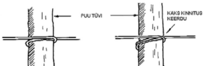
Pilt 5.8. Iga 200 meetri järel tehakse kaks kinnituskeerdu
