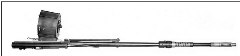
20mm Hispano-Suiza HS404 cannon (drum fed).
