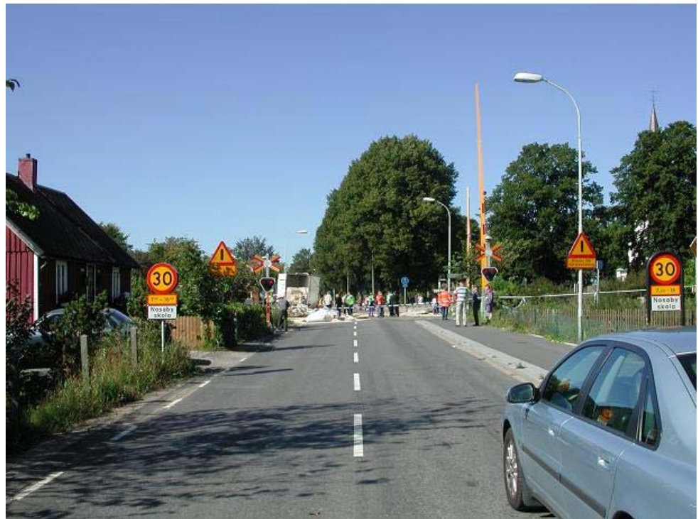
Vy mot olycksplatsen på eftermiddagen den 10 september. Här ses bl.a. 30-skyl- ten för Nosaby skola. Senare täcktes tilläggstavlor till denna över. Bortom 30- skylten syns "annan fara" med tilläggstavlan "stanna här vid köbildning". Väg- ljussignalen på kryssmärket blinkar ännu rött. Foto: Banverket.
