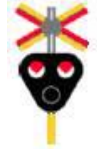
Kryssmärkesstolpe med vägljussignal ("kastljus")
