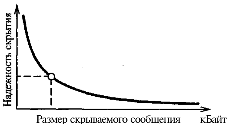
Рис. 2.2. Взаимосвязь между устойчивостью стеганосистемы и объемом скрываемого сообщения при неизменном размере файла-контейнера
