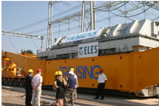
Slika 6. Transport PAR Divača – po železnici (zgoraj) in naprej po cesti (spodaj) [11]
