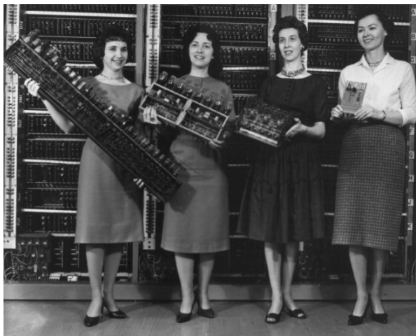
Slika 3. Primerjava ekvivalentnih elektronskih vezij različnih računalnikov od leve proti desni: računalnik ENIAC (1945), računalnik EDVAC (1949), računalnik ORDVAC (1951) in računalnik BRLESC-I (1961)
